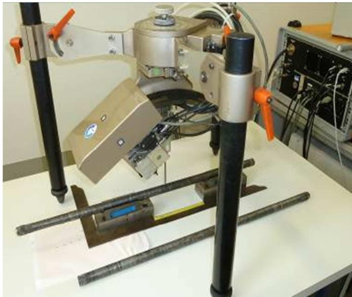
Figura 4.6 Equipamento portátil para medição de Tensões Residuais (difração de raios-X).
