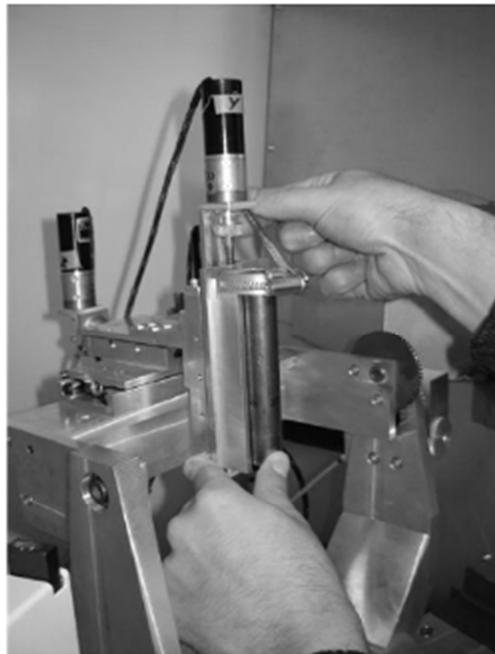
Figura 4.7 Fixação da amostra no equipamento de raios-x.
