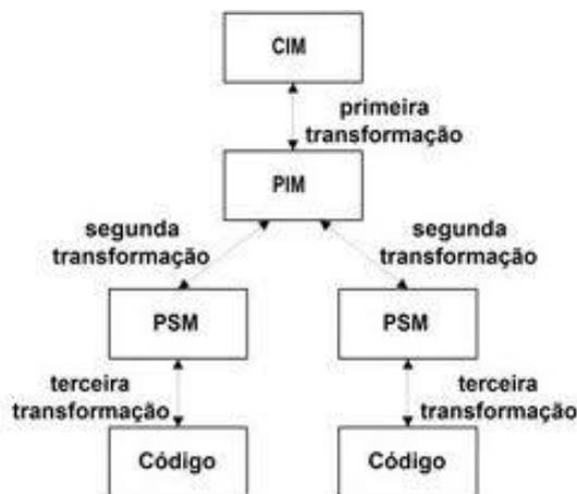
Figura 2.3: Fluxo utilizado para metodologia MDA.
