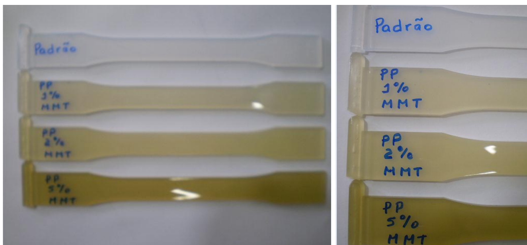
Figura 17. Corpos de prova de PP puro e dos nanocompósitos de PP/MMT conformados para os testes mecânicos.
