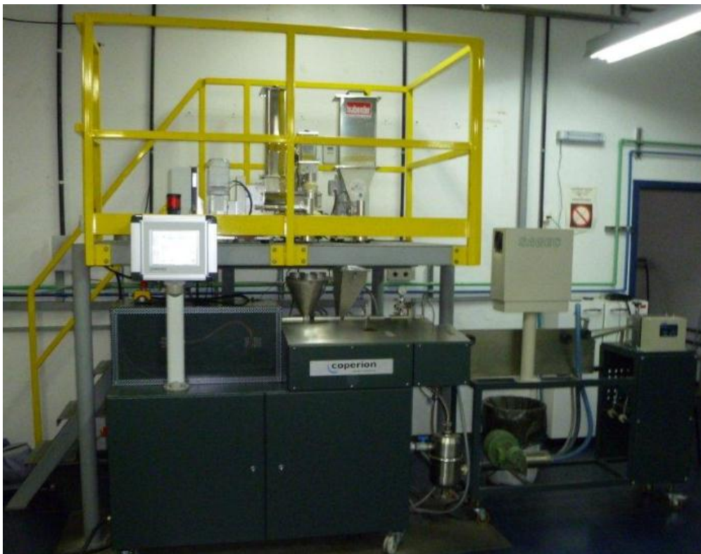
Figura 16. Extrusora utilizada para a obtenção dos nanocompósitos.
