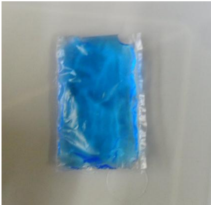
Figura 26. Embalagem dos filmes de nanocompósitos de PP/MMT contendo a solução de Azul de Metileno para o teste de degradação.
