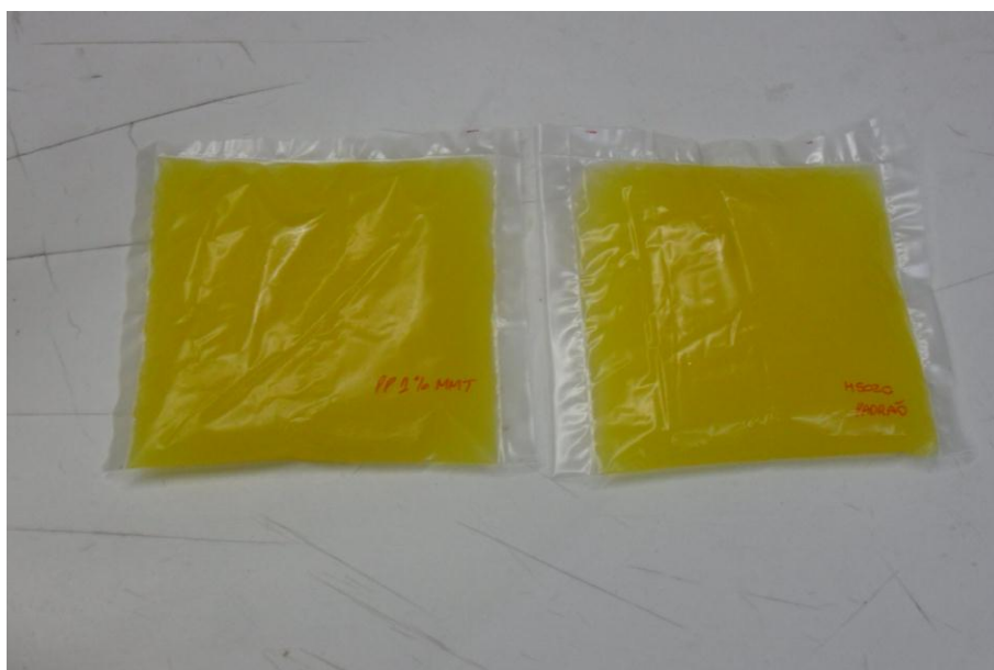
Figura 20. Suco de Laranja em contato com filmes de PP puro e nanocompósitos de PP/MMT.
