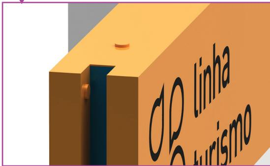
Detalhes dos parafusos passantes para fixação do corpo do totem na base concretada
