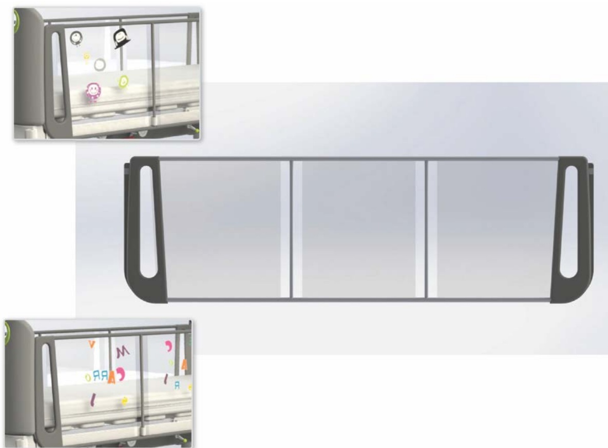
Figura 44- Modelo 3d da guarda desenvolvida e exemplos de aplicação de adesivos.
