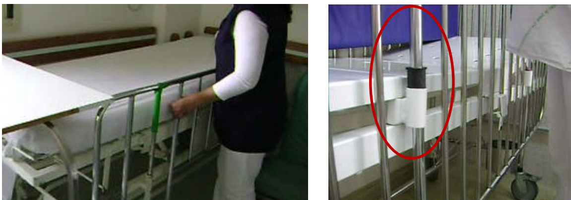
Figura 16 - Exemplo de guardas que exigem esforço para movimentar (Hospital da Criança Santo Antônio e Hospital da Criança Conceição, respectivamente).
