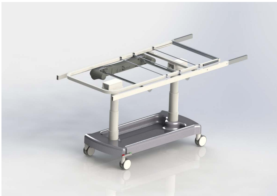
Figura 36 - Lastro estendido com atuador linear duplo.
