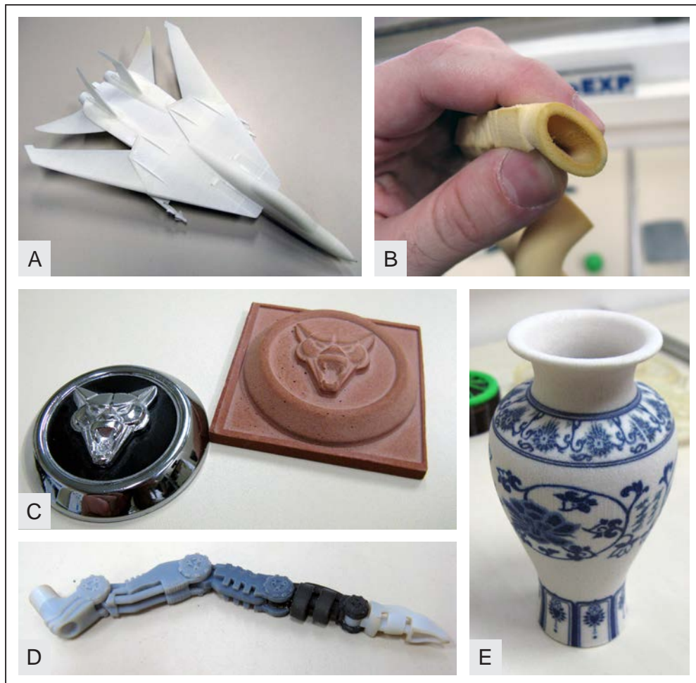
Figura 23 - Divisão de Tecnologias Tridimensionais - CTI: modelos construídos através dos processos de (A) SLS com material rígido, (B) SLS com material flexível, (C) digitalização tridimensional e usinagem com fresadora Roland, (D) impressão Polyjet com mistura de materiais rígido (branco) e flexível (preto), e (E) impressão tridimensional Z Corp colorida.
