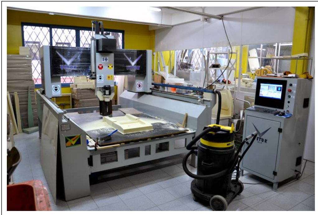
Figura 17 - Laboratório de Modelos Tridimensionais - INT: Instalações do laboratório, sala com fresadora CNC 3 eixos.
