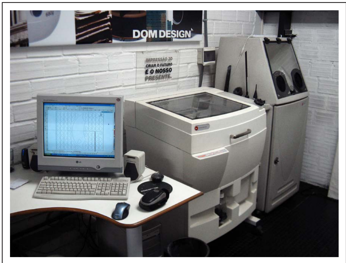
Figura 12 - DOM Design - Impressora tridimensional Z Corp com estação de pós-processamento.
