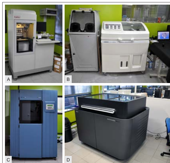
Figura 18 - Laboratório de Modelos Tridimensionais - INT: (A) Equipamento SLA Viper SI, (B) impressora tridimensional Z Corp colorida, (C) impressora 3D FDM Vantage i e (D) impressora tridimensional Polyjet Connex 350.
