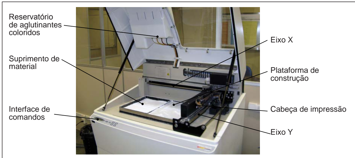
Figura 42 - ZCorp 510: detalhe da câmara de construção.
