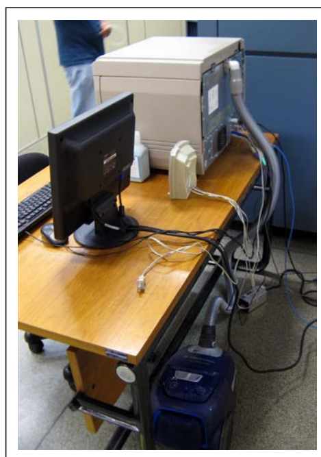
Figura 37 - Benchtop R66+ utilizando aspirador de pó doméstico como coletor.
