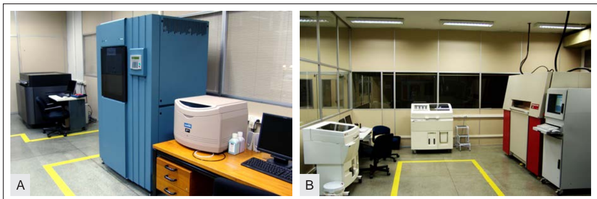
Figura 22 - Divisão de Tecnologias Tridimensionais - CTI: Instalações do local com (A) impressoras 3D Polyjet, FDM e Benchtop, (B) Impressoras 3DP Z Crop e SLS.
