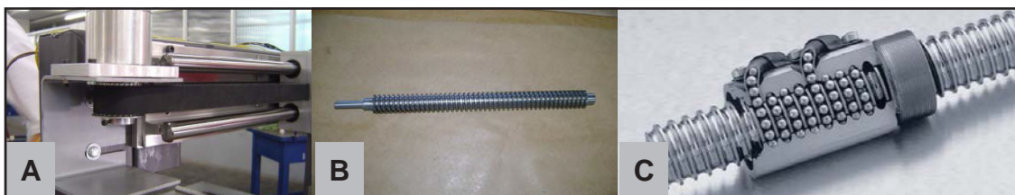
Figura 67 - Conversores de movimento: (A) Polia sincronizadora, (B) fuso trapezoidal, e (C) fuso de esferas recirculantes.
