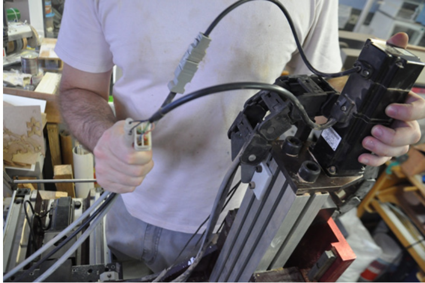
Figura 52 - Fixação do servomotor do eixo Z acima do spindle.
