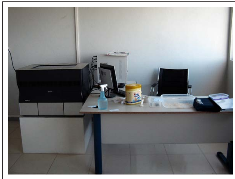
Figura 14 - Versus Design - Ambiente de trabalho com impressora 3D Objet Alaris30 e instrumento utilizados para pós-processamento.
