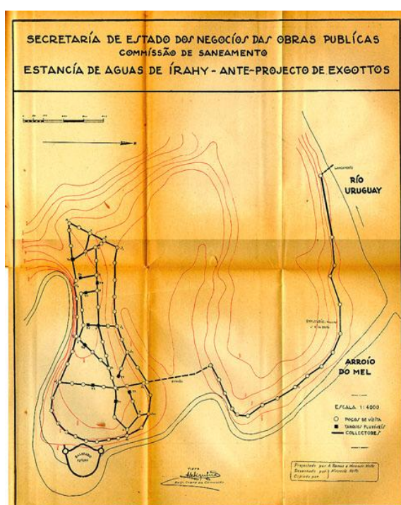
Figuras 202 e 203: À esquerda (Figura 202): “Estancia de Aguas de Irahy – Ante-Projecto de Exgotos” (SOP, Relatório de 1930a, 1 v., s/p.). À direita (Figura 203): “Estancia de Aguas de Irahy – Ante-Projecto de Aguas” (SOP, Relatório de 1930a, 1 v., s/p.). No canto à direita e abaixo de ambas as imagens dos projetos, situam-se as autorias dos projetos e desenhos. No entanto, por ser de difícil leitura gráfica, não foi possível a identificação de todos esses profissionais. No anteprojecto de esgotos, foi possível identificar que a autoria é atribuída aos engenheiros Miranda Netto e A. Ramos, da mesma forma que o desenho também é deste último profissional. Já o anteprojecto de águas tem sua autoria referenciada como sendo de A. Ramos, contudo o outro autor do projeto, assim como do desenho, não foi possível identificar 811 .
