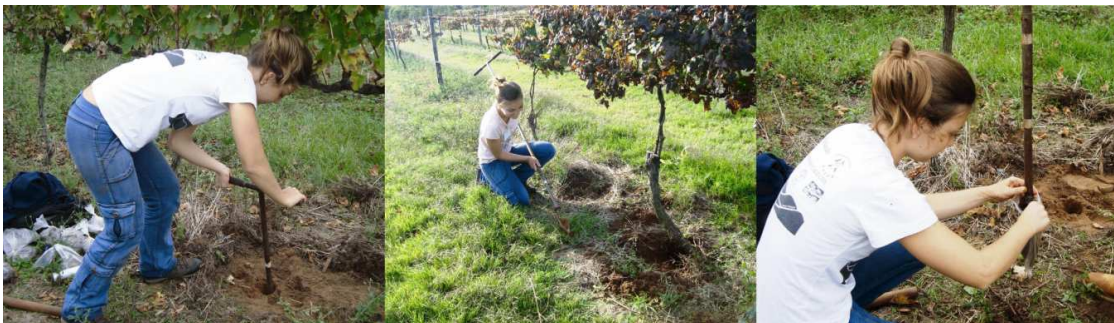
Figura 6: Amostragem do solo com trado manual no pé da videira e entre as videiras e acondicionamento da amostra em saco plástico.
