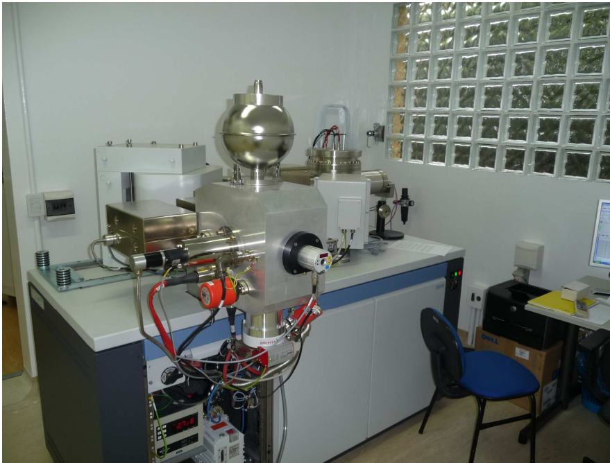
Figura 13: Foto do equipamento TIMS Thermo-Finnigan, modelo Triton no Laboratório de Geologia Isotópica da UFRGS. (Disponível em: http://www6.ufrgs.br/labiso/infra.html ).
