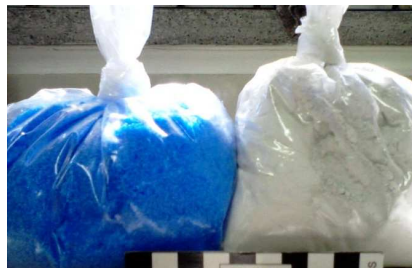
Figura 9: Amostra de sulfato de cobre (esquerda) e cal virgem (direita) utilizados na preparação de calda bordalesa.
