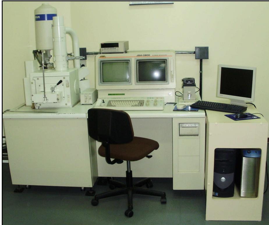
**Figura 8.** Microscópio Eletrônico de Varredura JEOL - JSM 5800® do CME - IF - UFRGS.
