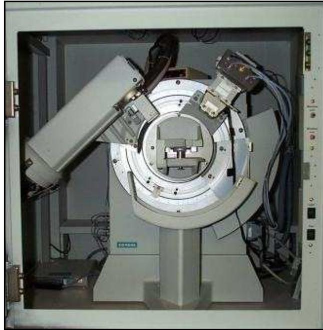
**Figura 10.** Difratorômetro SIEMENS - D 5000®.
