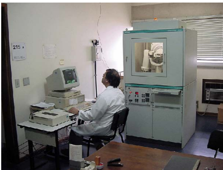
Figura 12. Difratômetro SIEMENS D5000 com goniômetro \theta - \theta do Laboratório de Difractometria de Raios X, IGeo, UFRGS (Fonte: http://www.cpgq.ufrgs.br/arquivos/lab.htm ).
