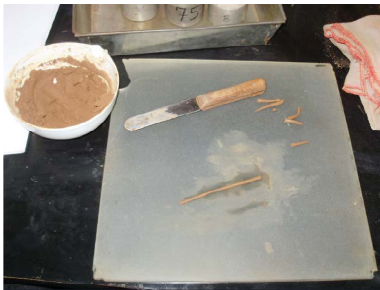
Figura 14. Cilindro com 3 mm de diâmetro e cerca de 100 mm de comprimento.
