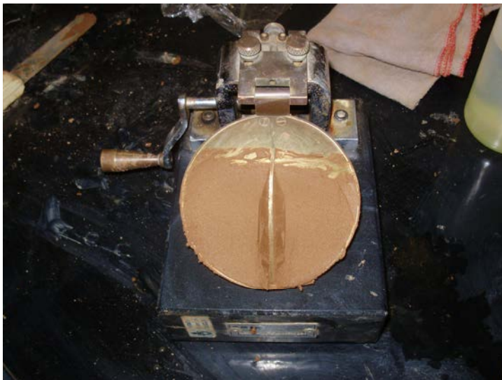
Figura 13. Aparelho de Casagrande com a ranhura aberta na pasta de solo.
