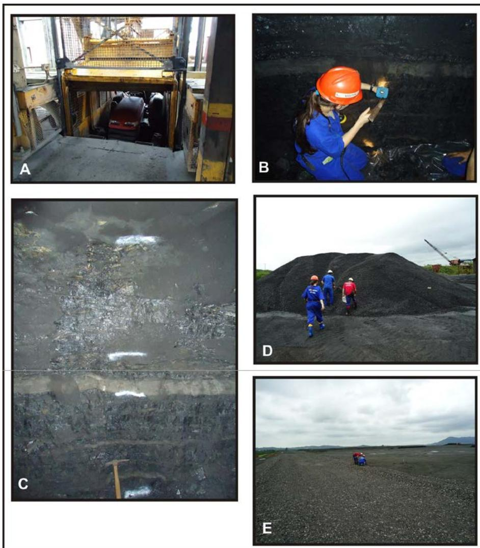
Figura 5: Coleta de carvão na Mina Verdinho. A) entrada da mina, por elevador; B) coleta de carvão na camada; C) camada de carvão Barro Branco, onde foi realizada a amostragem, com intervalos demarcados (Banco, Quadrção com siltito Barro Branco e coringa, Forro); D) coleta de carvão beneficiado; E) coleta de rejeito.
