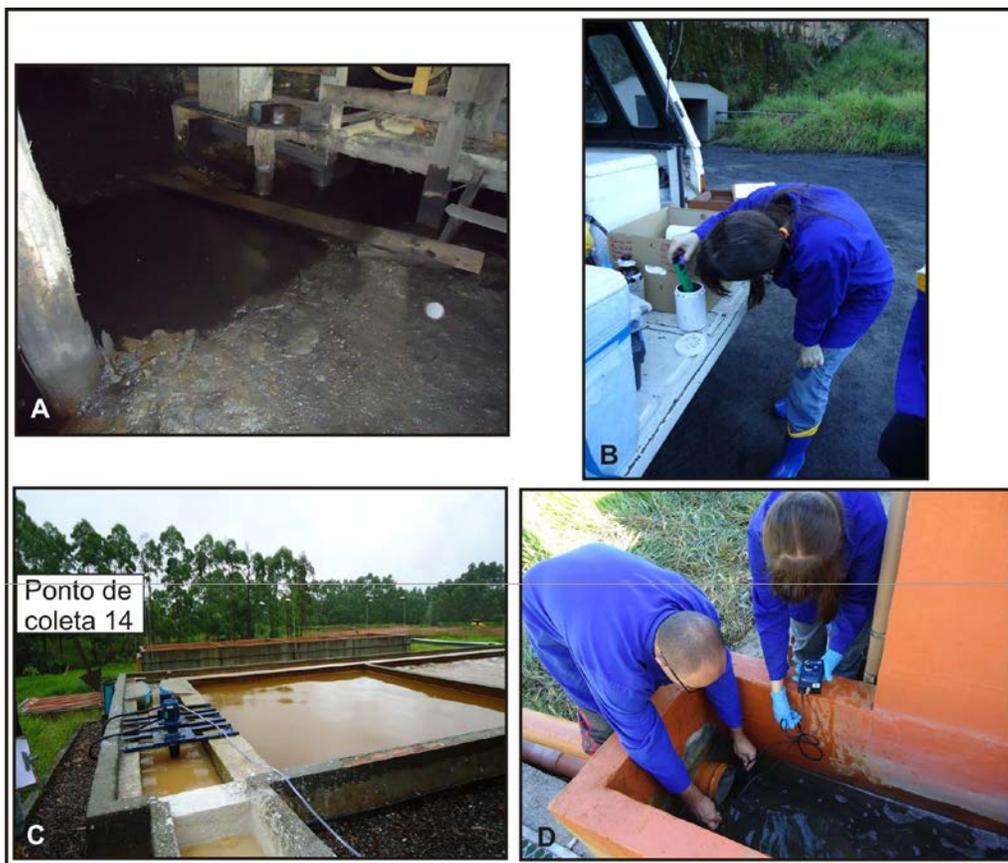
Figura 7: Coleta de água na Mina Morrozini. A) local de coleta do ponto 13, na entrada da mina; B) amostragem e medições ponto 13; C) vista dos tanques do sistema de tratamento de água, com detalhe para o local de coleta do ponto 14; D) amostragem e medições do ponto 14.
