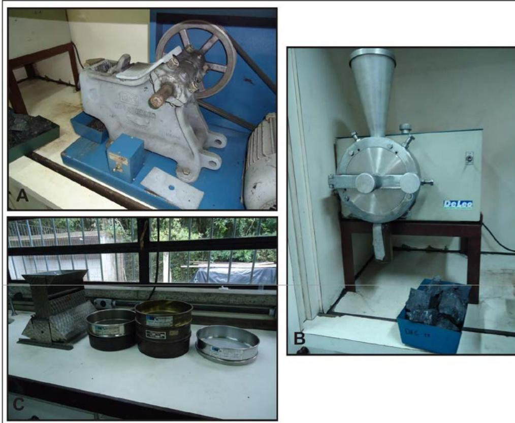
Figura 10: Preparo de amostras de carvão. A) britador para trituração de amostras; B) moinho para pulverização de amostras de carvão; C) quarteador e peneiras.
