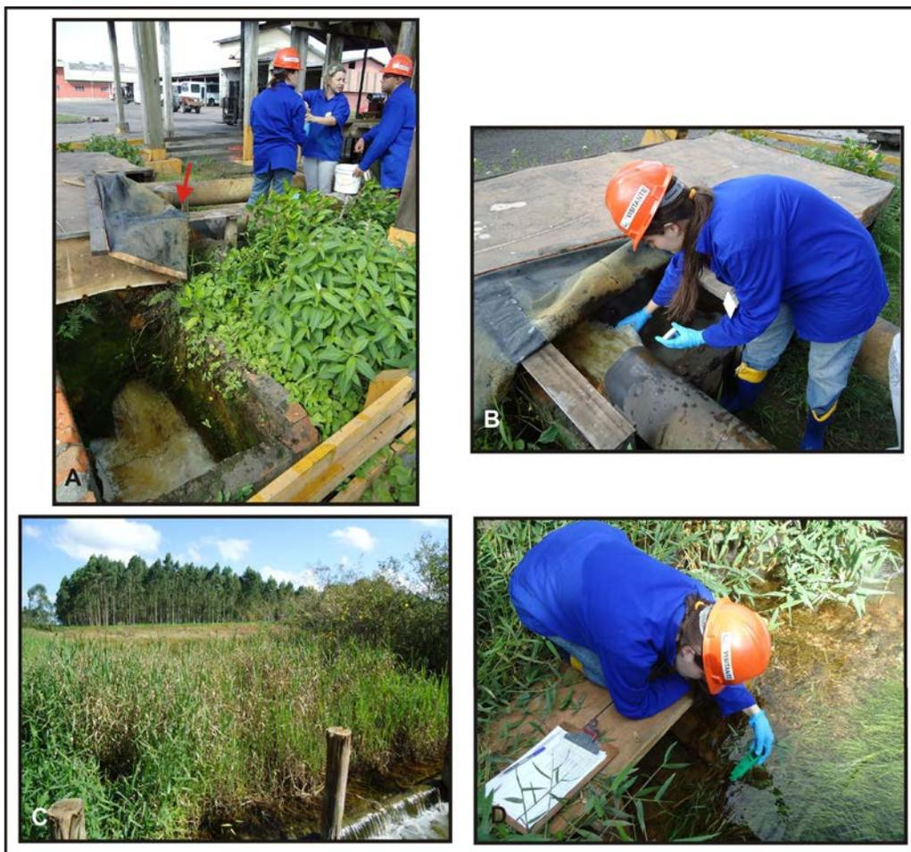
Figura 8: Amostragem de água na Mina Verdinho. A) saída de água de subsolo da mina, indicada pela flecha, ponto de coleta 07; B) amostragem de água no ponto 07; C) bacia biológica de tratamento *wetland*, ponto de coleta 06; D) amostragem de água no ponto 06.
