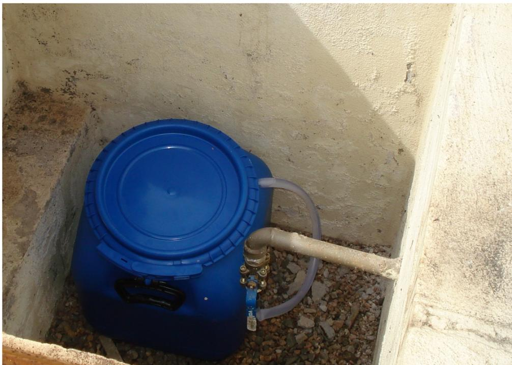
Figura 4.5: Reservatório para análise de qualidade de água dos pavimentos permeáveis.
