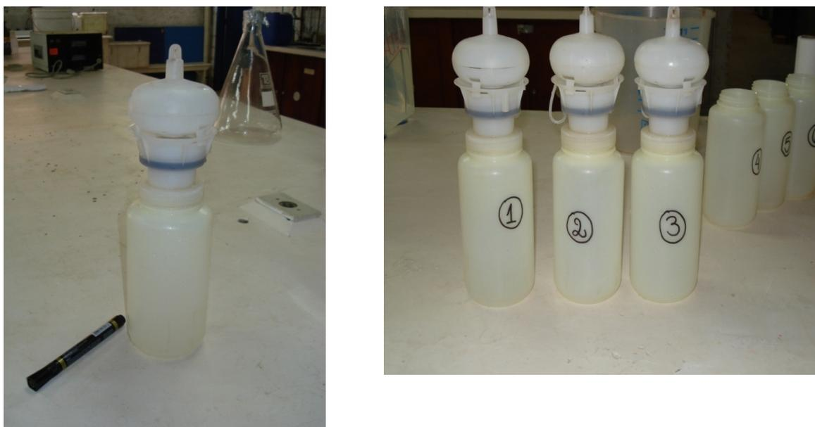
Figura 4.6: Garrafas de amostragem de escoamento superficial
