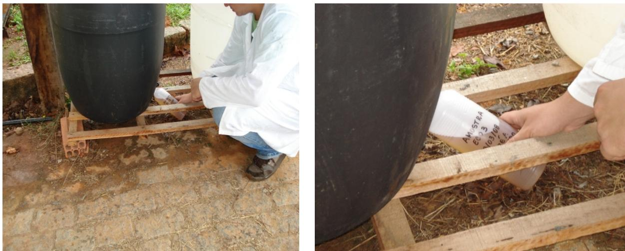
Figura 4.12: Coleta de amostra de água no reservatório da cobertura verde.
