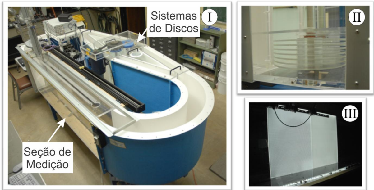
Figura 3.9 – Modelo Físico utilizado por Puhl et al. (2010) em experimentos da quantificação do carreamento da mistura (I) Tanque Odell-Kovaszny (II) discos giratórios para geração do escoamento (III) placa de iluminação uniforme.
