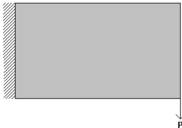
Figura 22: Problema 4 (placa de dimensões 0,08 \times 0,05 \times 0,001 m, com carga na extremidade inferior direita).
