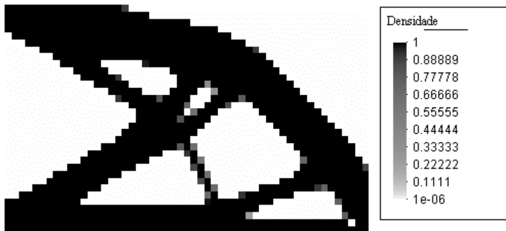
Figura 89: Resultado para viga com carga na ponta, malha com 1749 elementos e raio de 0,002m.
