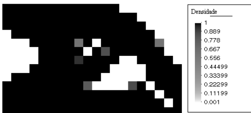
Figura 131: Topologia obtida para uma filtragem continuada, variando o ajuste de peso de 0,5 a 0,1 em cinco níveis.
