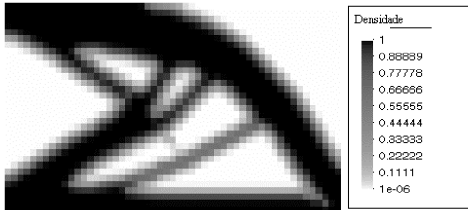
Figura 123: Topologia obtida para o problema de minimização de volume com restrição de flexibilidade para a viga do problema 4 com 1749 elementos, após convergência do primeiro nível de otimização (com filtragem).
