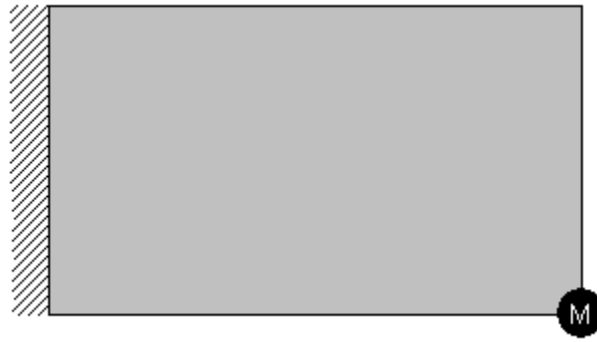
Figura 25: Problema 7 (placa de dimensões 8 \times 5 \times 1 , com massa concentrada no nó do canto inferior direito).
