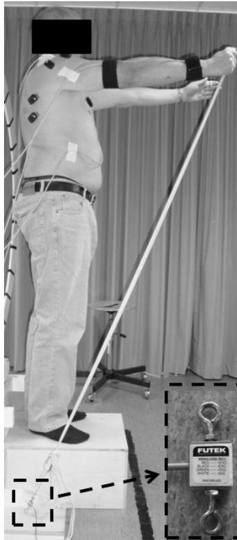
Figura 4.1. Resistência elástica e célula de carga. O dispositivo semicircular utilizado de referência para os movimentos de elevação foi temporariamente retirado para deixar a figura mais clara.
