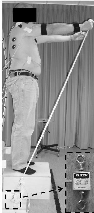
Figura 3.1. Resistência elástica e célula de carga. O dispositivo semicircular utilizado de referência para os movimentos de elevação foi temporariamente retirado para deixar a figura mais clara.
