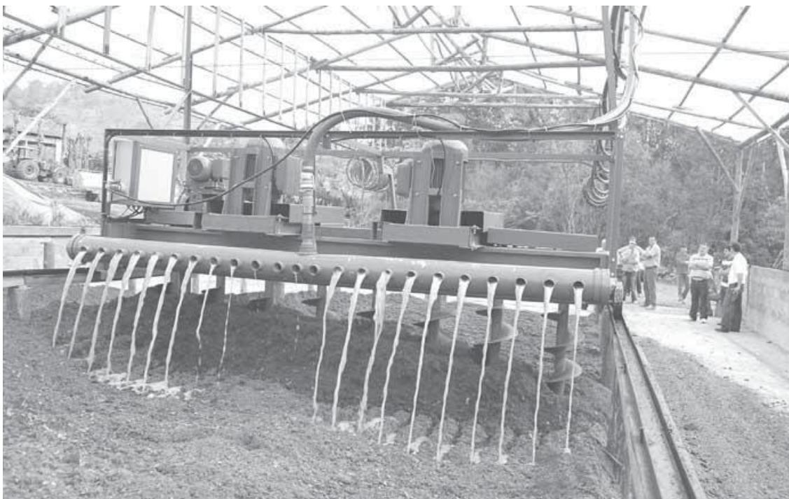
Foto 38 - Demonstração do lançamento de dejetos sobre material seco que absorve a umidade na unidade mecanizada e automatizada (UMAC) da propriedade dos irmãos Kummer – Itapiranga/SC
