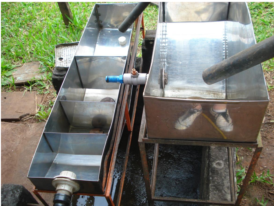
Foto 34 – Depurador e filtrador do caldo de cana na “agroindústria de derivados de cana Mueller”, de Linha Santa Cruz, município de Itapiranga/SC.
