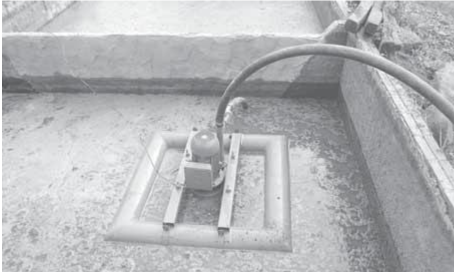
Foto 37 - Bomba de sucção dos dejetos para uma máquina de processamento na unidade mecanizada e automatizada (UMAC) da propriedade dos irmãos Kummer – Itapiranga – SC
