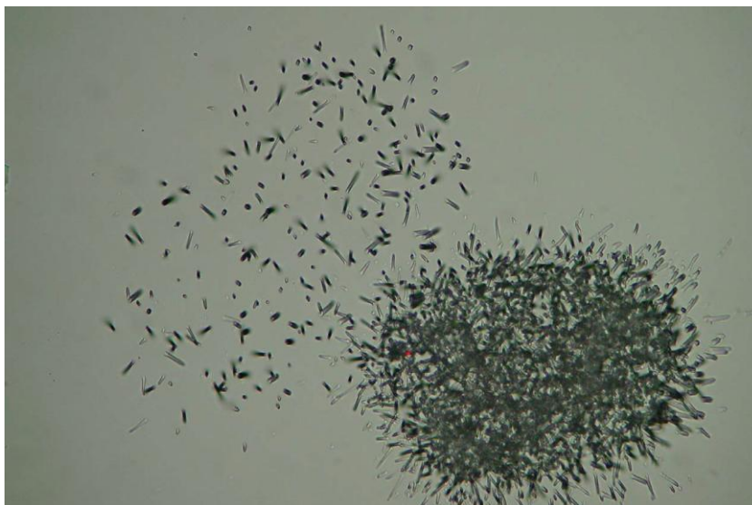
Figura - 2.3. Fotomicrografia do par apatita e detector. A densidade da fissão do ^{238}\text{U} observada nos grãos de apatita (à direita) é denominada de traços espontâneos e a do ^{235}\text{U} observada no detector externo (à esquerda), traços induzidos (extraído de Grist & Zentilli, 2005).
