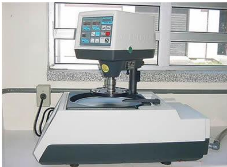
Figura - 2.20. Fotografia da politriz Buehler, modelo Ecomet 4 do Laboratório de Preparação de Amostras do IG/UFRGS.
