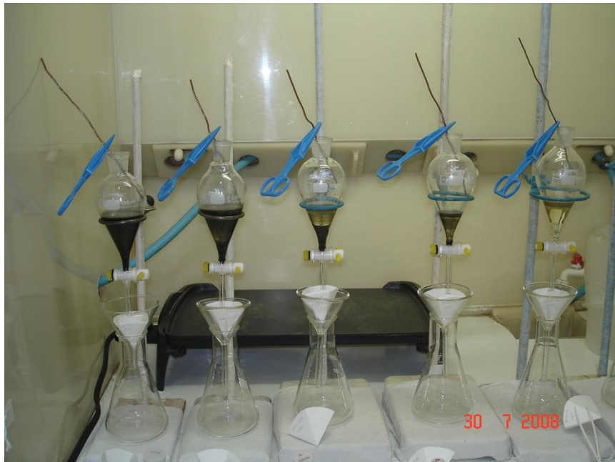
Figura - 2.16. Balões de decantação preenchidos com Di-diodometano em capela de exaustão (Laboratório de Preparação de Amostras do IG/UFRGS).
