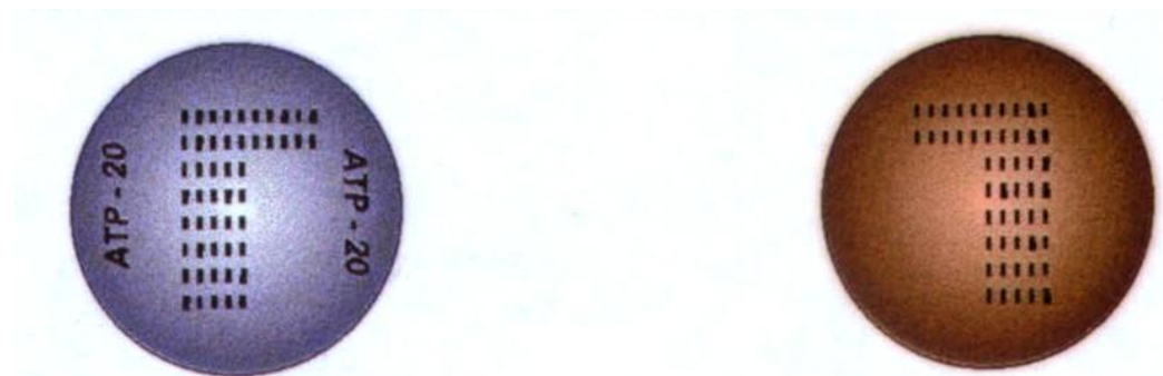
Figura - 2.22. Esquema ilustrativo da montagem dos grãos de apatita na pastilha e respectiva imagem no detector, após irradiação e revelação.
