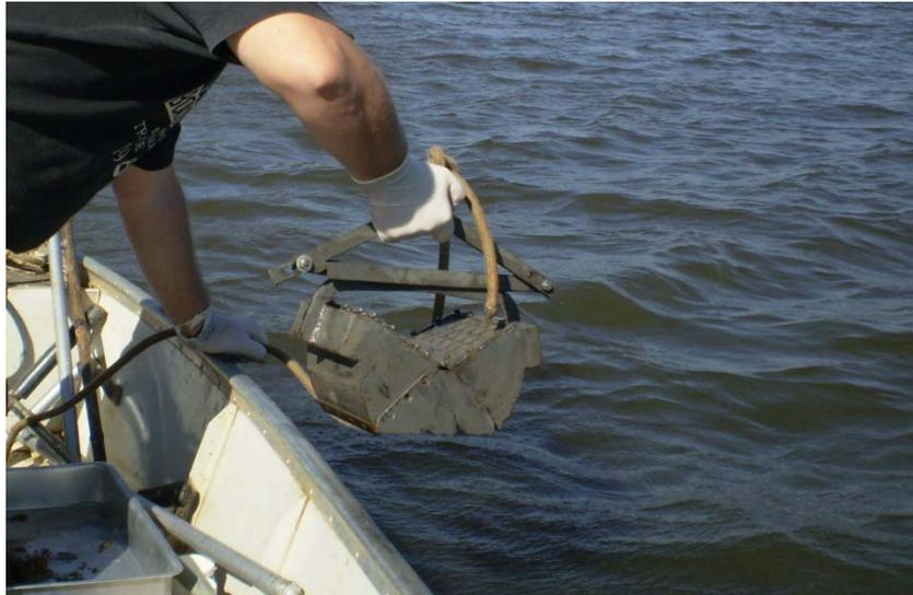
Figura 6. Amostragem de sedimento com draga VAN-VIN.
