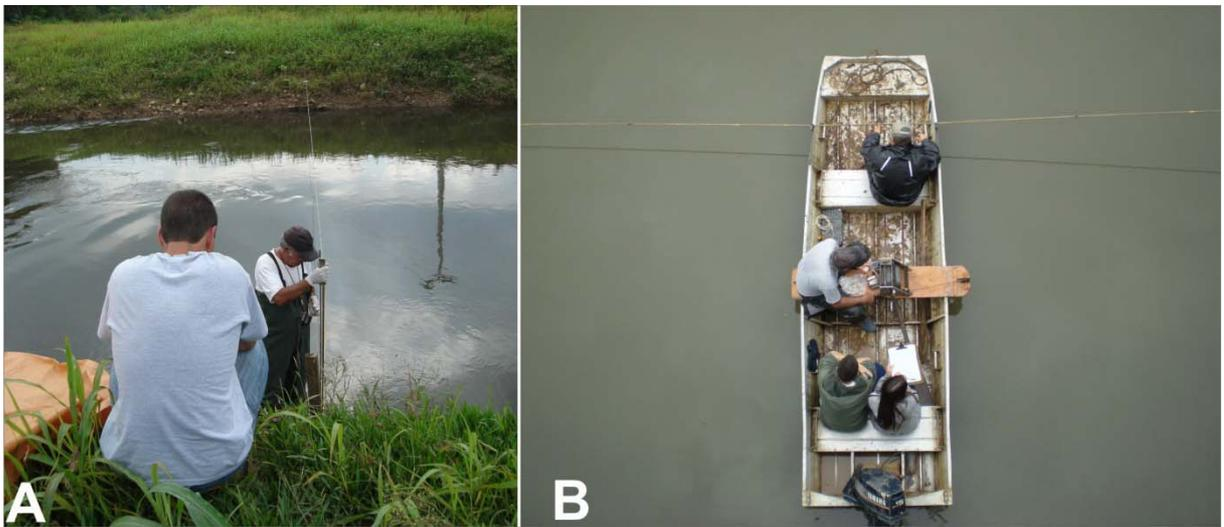
Figura 3. Leitura da velocidade da corrente com molinete.
