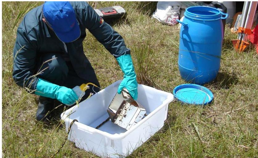
Figura 4. Descontaminação de equipamento por hexano acondicionado em pisseta. Os resíduos são coletados em bacia e em seguida armazenados em bombonas até serem entregues na REPAR para disposição final.
