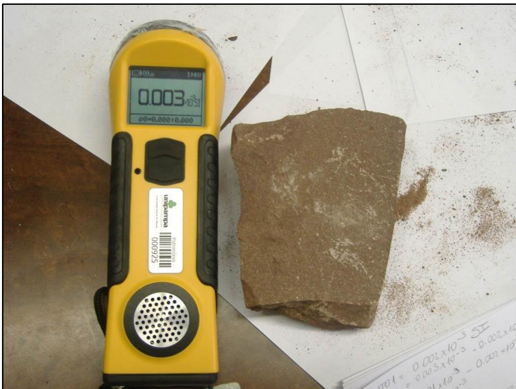
Foto 3: Susceptibilímetro KT-10 utilizado para aquisição dos valores de susceptibilidade magnética.
