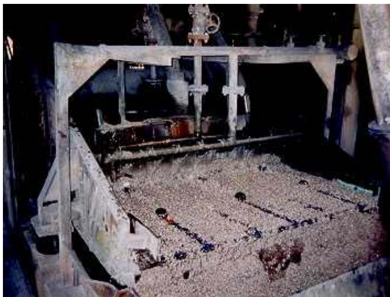
Figura 14. Peneira de lavagem do tanque de meio-denso, fração grosseira.
