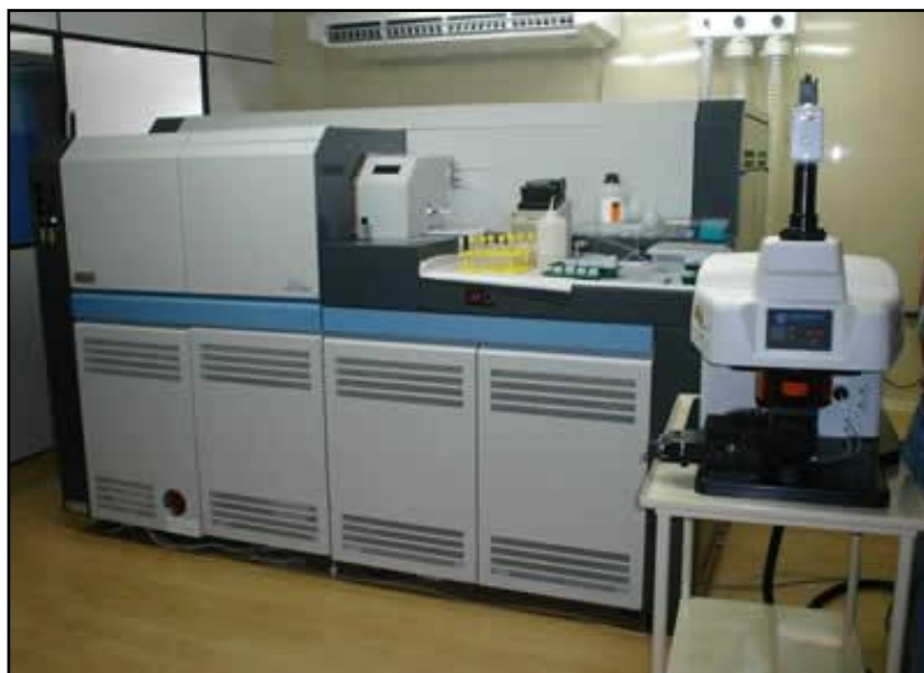
Figura 4 – Ilustração do MC-ICP-MS Neptune (ThermoFinnigan) com a microsonda a laser UP213 (New Wave) acoplada, utilizados para as análises in situ de U-Pb em zircão no LGI-UFRGS.
