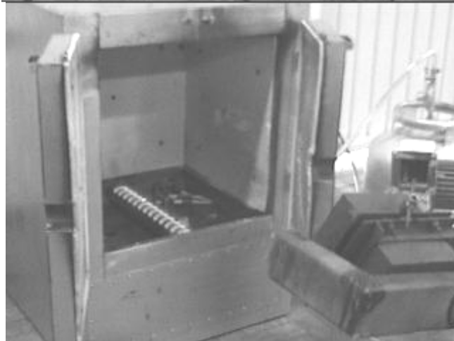
Figura 3.5: Protótipo de rotomoldadora: a) forno fechado e b) forno aberto e molde cúbico.
