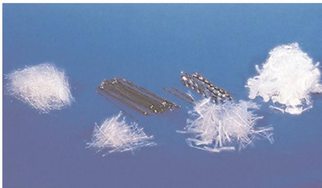
Figura 2.1 – Fibras de distintos materiais, comprimentos e formas, que podem ser utilizadas no concreto (adaptado de Kosmatka *et al.*, 2003).
