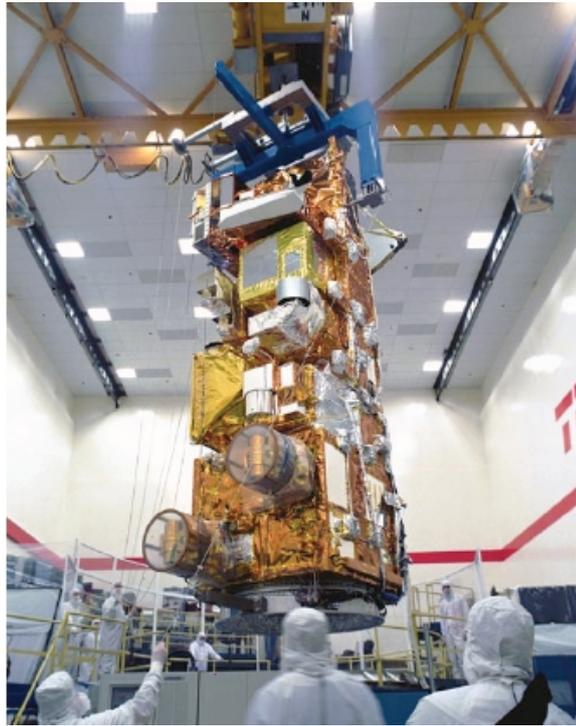
Figura 4.18: Foto do satélite AQUA na fase de preparação para o lançamento. Os dois instrumentos CERES são visíveis próximos da base do satélite e estão com a estrutura de proteção. O sensor HSB é visível acima do instrumento CERES à direita. O AIRS está posicionado logo à esquerda. Acima do HSB, pode ser visto o sensor AMSU. O instrumento MODIS está localizado no topo à esquerda. Fonte: Parkinson, C. L. (2003).
