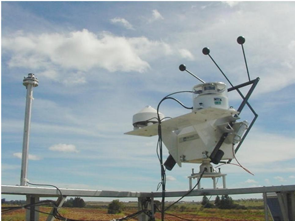
Figura 4.10: Vista de alguns radiômetros da estação de referência na cidade de Brasília, DF. Observa-se o sensor PAR à esquerda e rastreador solar com os sensores de radiação difusa, direta e onda longa à direita. Fonte: INPE/CPTEC.
