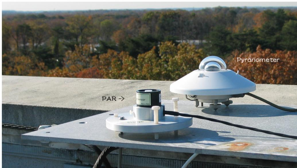
Figura 4.11: Foto mostrando o instrumento SKE-510 PAR produzido pela indústria Skye para medida da radiação PAR e o piranômetro Kipp e Zonen modelo CM-21 utilizados nas estações da rede Solrad-Net. Fonte: SolRad-Net/NASA.
