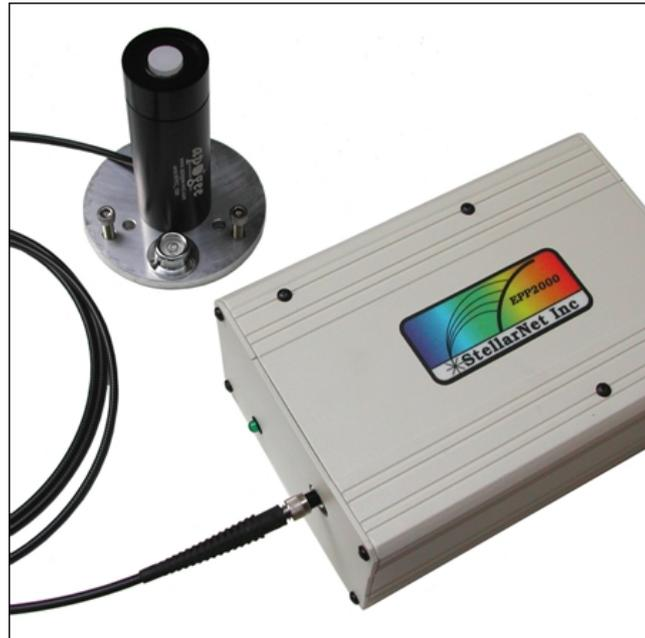
Figura 4.4: Espectrorradiômetro APOGEE modelo EPP2000 com resposta espectral entre 300 e 1000 nm.
