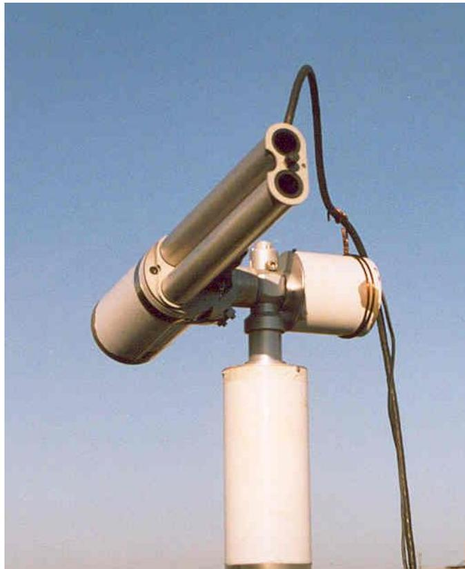
Figura 4.7: Foto do radiômetro automático CIMEL-318 existente nas estações da rede AERONET. Fonte: [www.cimel.fr](http://www.cimel.fr).
