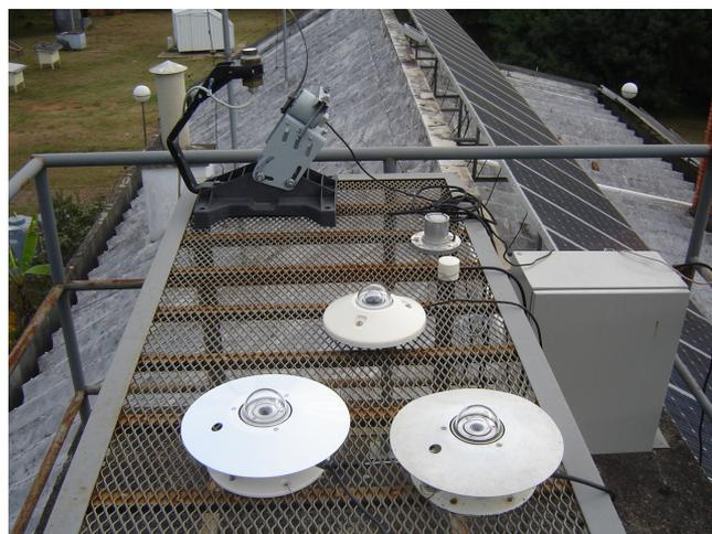
Figura 4.2: Fotografia da plataforma de medidas de radiação solar do Laboratório de Energia Solar, UFRGS. Além dos piranômetros é visto um espectrorradiômetro com anel de sombra rotativo
