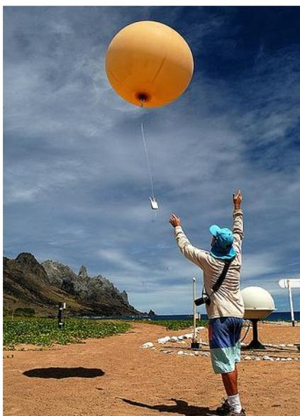
Figura 4.16: Foto mostrando o balão com radiossonda no momento do lançamento.
