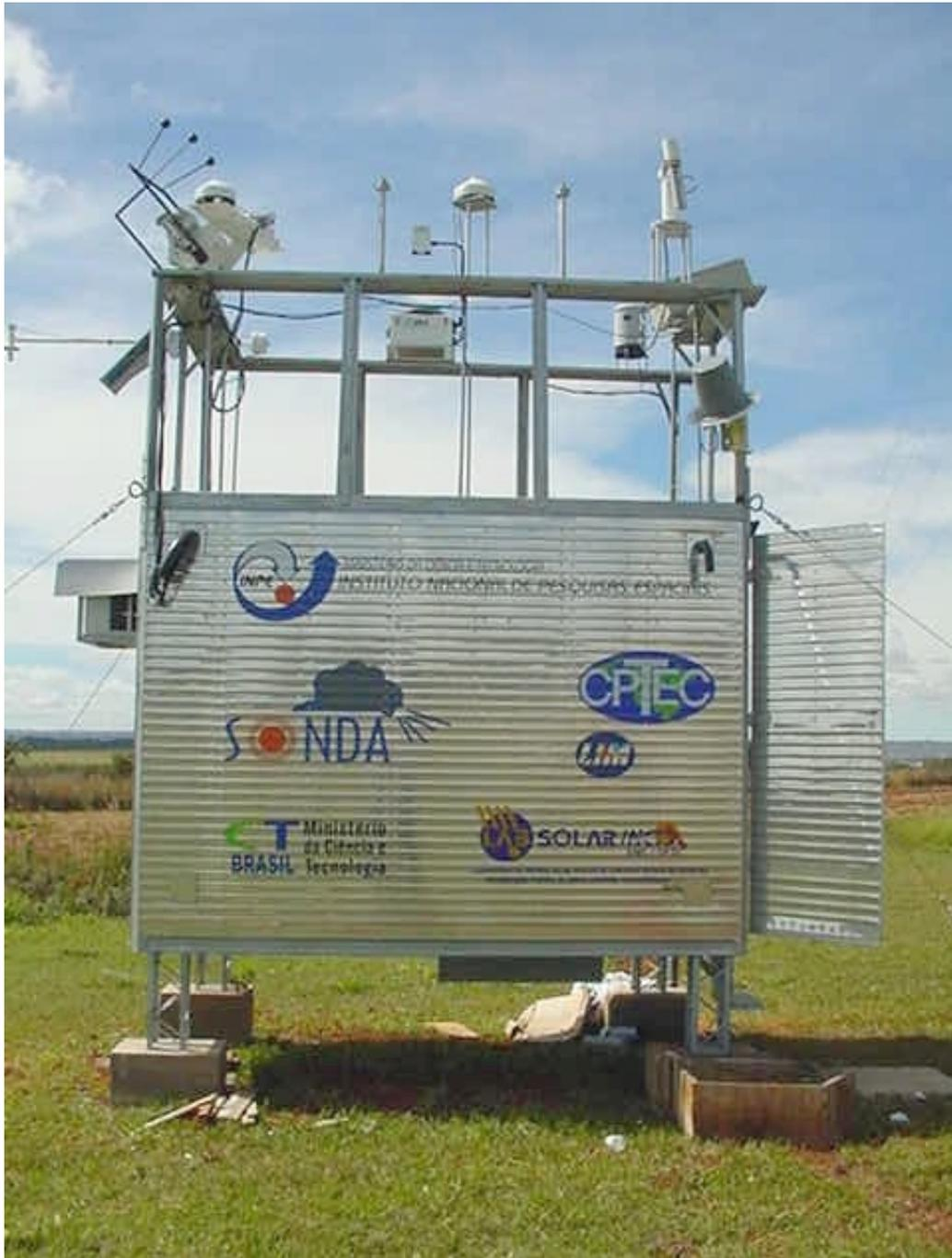
Figura 4.9: Estação de referência na cidade de Brasília, DF. Observam-se os diversos instrumentos solarimétricos da rede SONDA e AERONET. Fonte: INPE/CPTEC.
