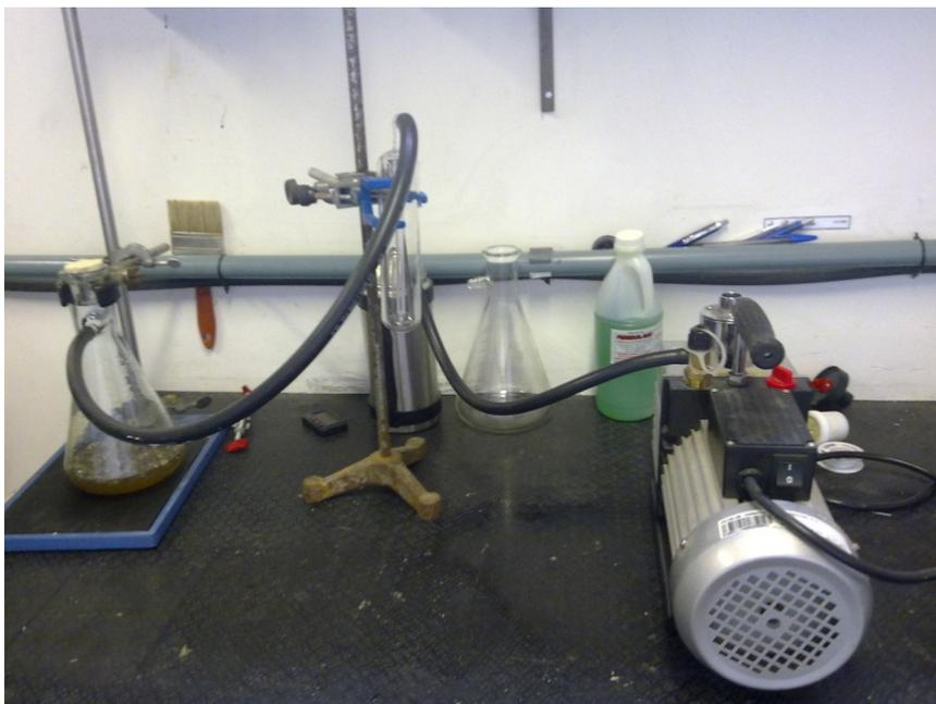
**Figura 19 – Sistema a vácuo de evaporação do solvente**
