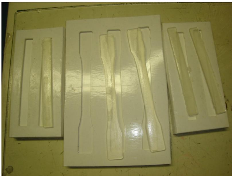
**Figura 21 – Moldes de silicone utilizados e corpos de prova após desmoldagem**
