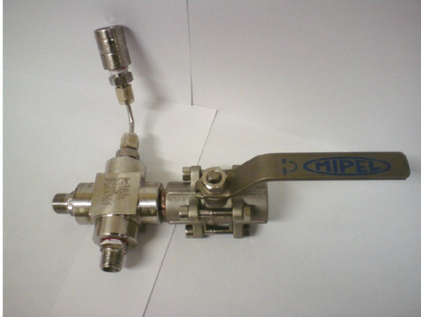
Figura 4.3 – Fotografia da câmara para gás ( V_A' ) do sistema de duplo volume.
