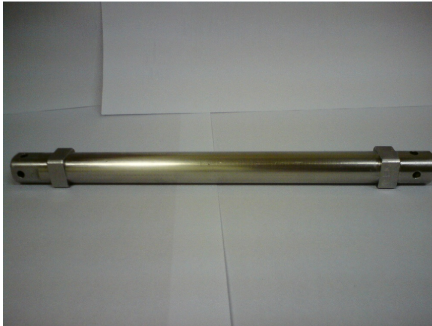
Figura 3.1 – Extensor ou faca de espalhamento em aço inoxidável.
