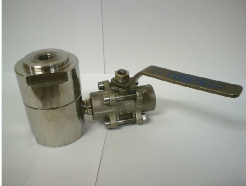
Figura 4.2 – Fotografia da câmara para amostra ( V_B ) do sistema de duplo volume.
