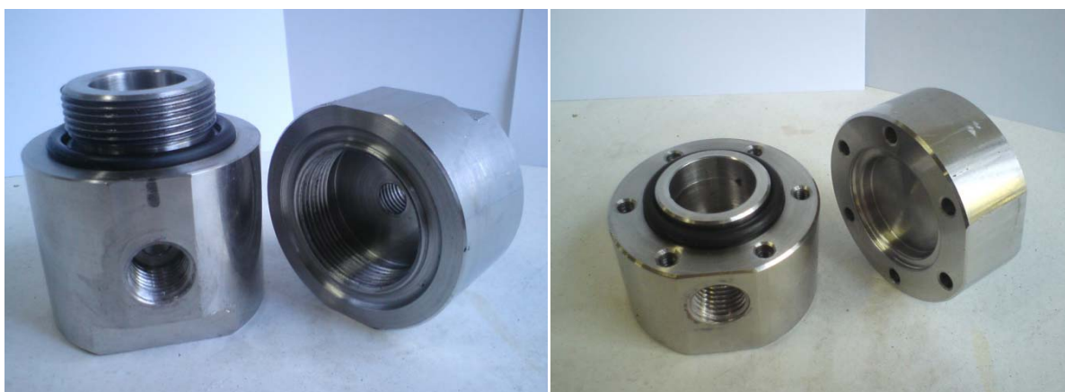
Figura 4.1 – Fotografias da célula de amostra ( V_B ) e da célula de gás ( V_C ).
