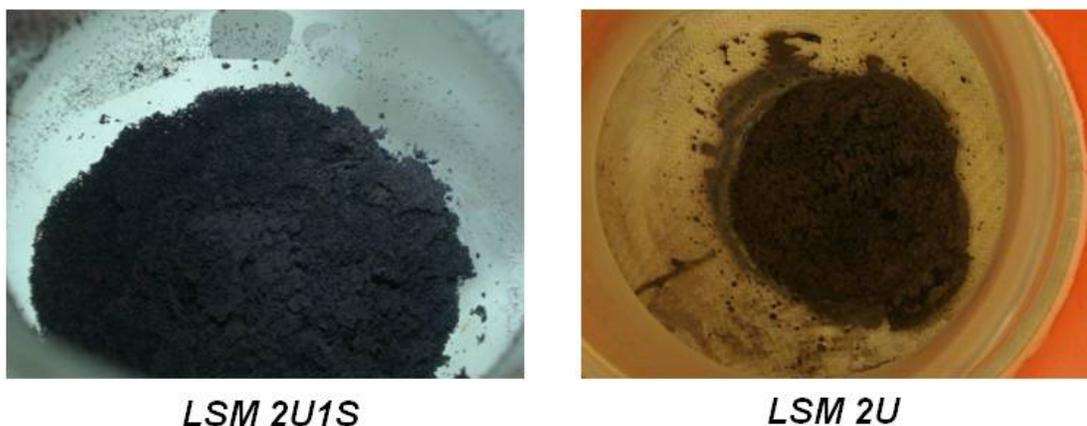
Figura 13: Aspecto dos pós obtidos no balão volumétrico de 1 litro, logo após as sínteses por reação de combustão.
