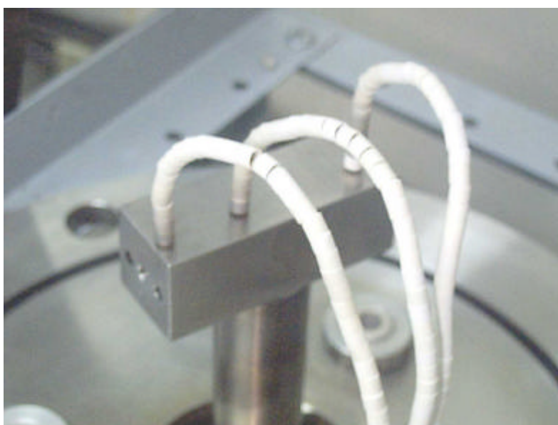
Figura 8: Disposição dos termopares nas amostras
