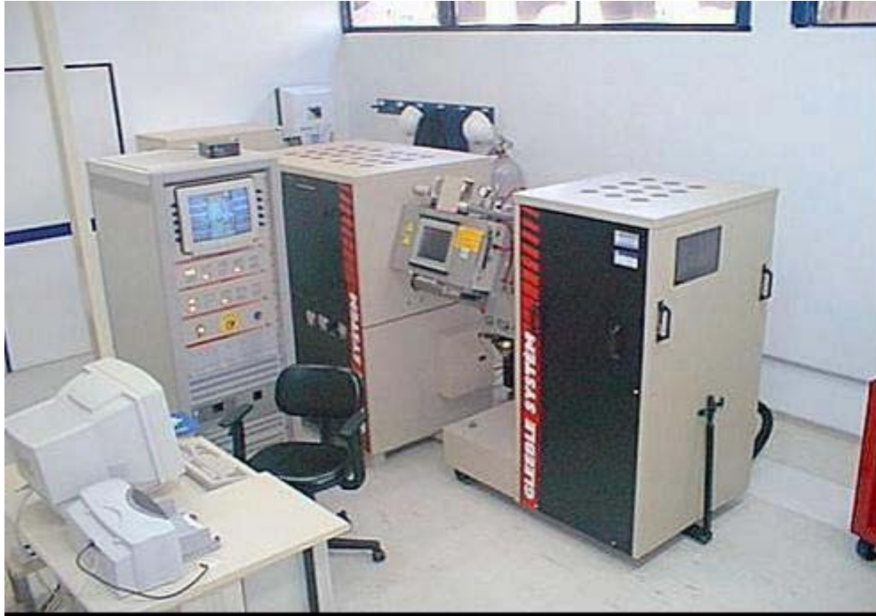
Figura 3.8 Visão geral do simulador Gleeble 3500.
