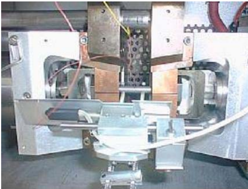
Figura 3.17 Câmara de vácuo da Gleeble 3500 com o corpo de prova em posição para iniciar o teste.
