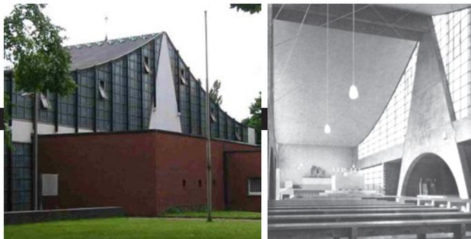
dois pilares triangulares, em concreto, abertos em meia-lua na base e dispostos na altura média do lado maior da planta, onde estão presos os tirantes que sustentam a cobertura, tensionada, de duas águas. Os pilares destacam-se pelo desenho em meio ao pano de vidro onde estão inseridos, vidros que levam efusiva iluminação, de ambos os lados, para o altar colocado centralmente, legando recinto surpreendente e um tanto original.
