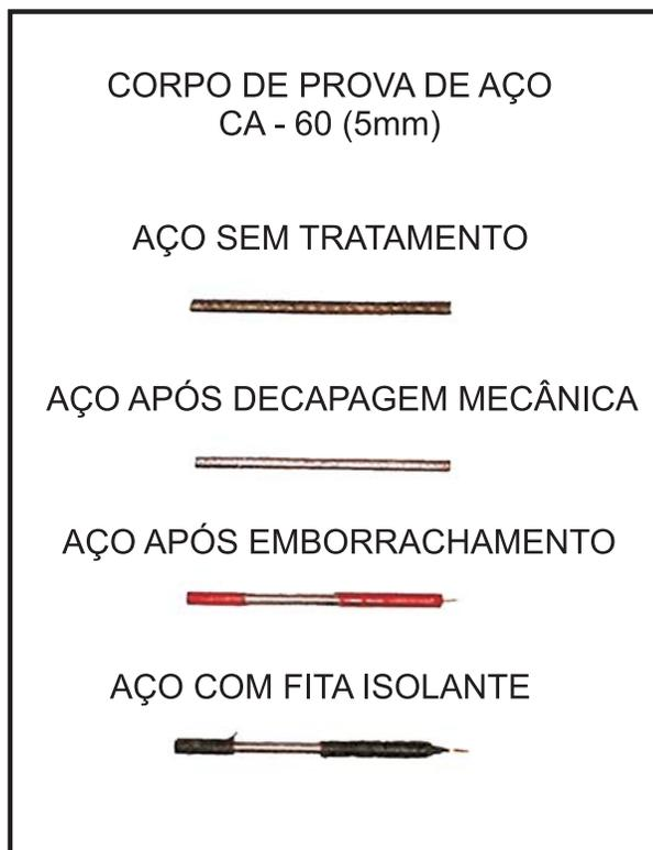
**Figura 3.8** - Preparação da barra de aço
