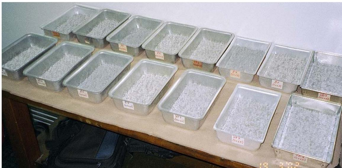
**Figura 3.10** - Bandejas com c.p. triturados para determinação da umidade de equilíbrio
