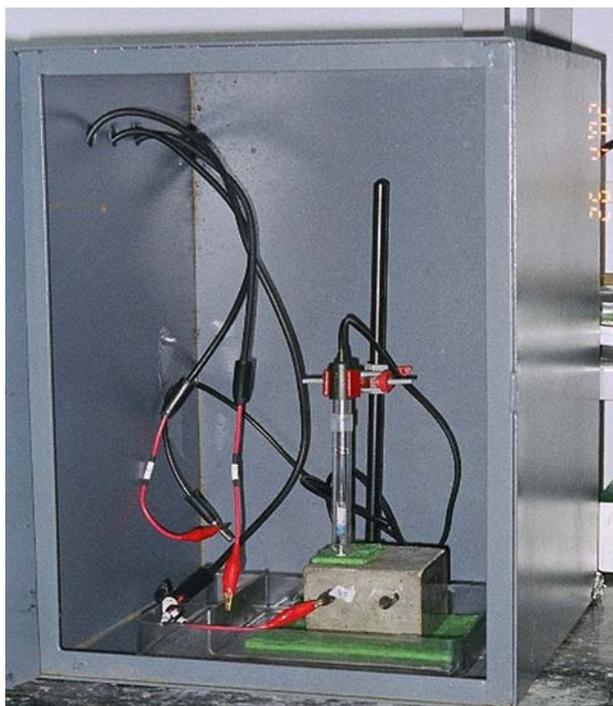
**Figura 3.14** - Célula de trabalho para o ensaio de resistência de polarização
