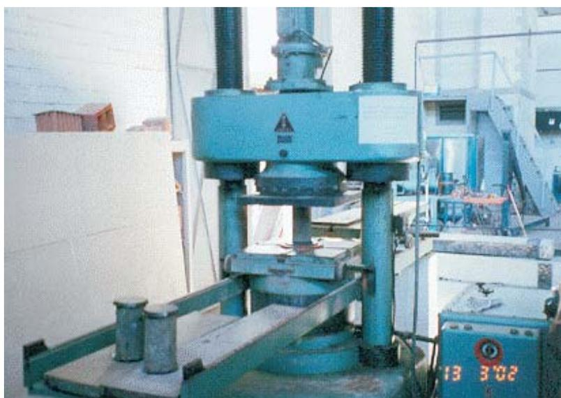
**Figura 3.15** - Ensaio de resistência à compressão axial
