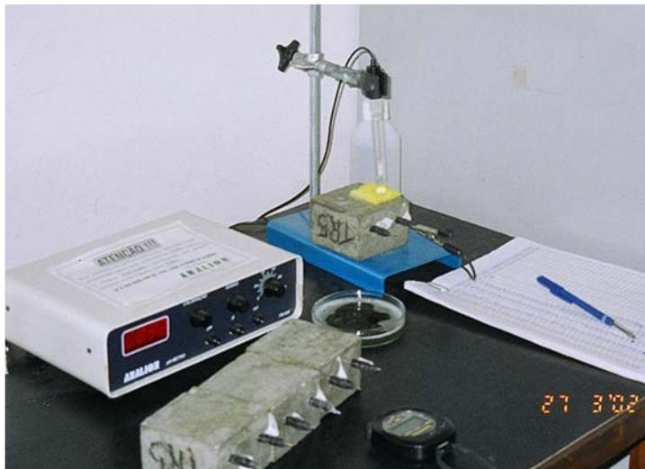
**Figura 3.13** - Ensaio de potencial de eletrodo ou de corrosão
