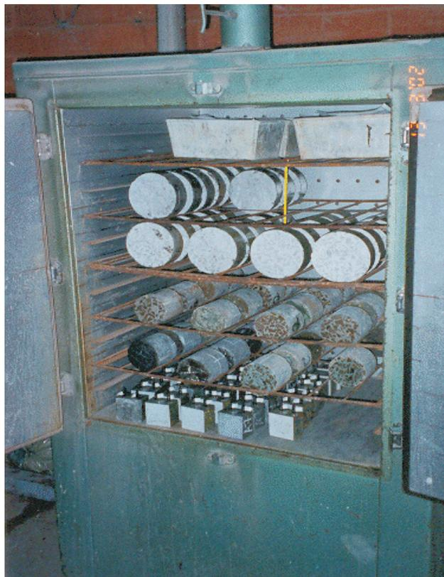
**Figura 3.11** - Corpos-de-prova na estufa para ajuste da umidade interna
