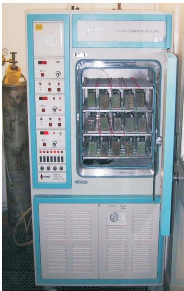
**Figura 3.1 - Câmara de carbonatação**
