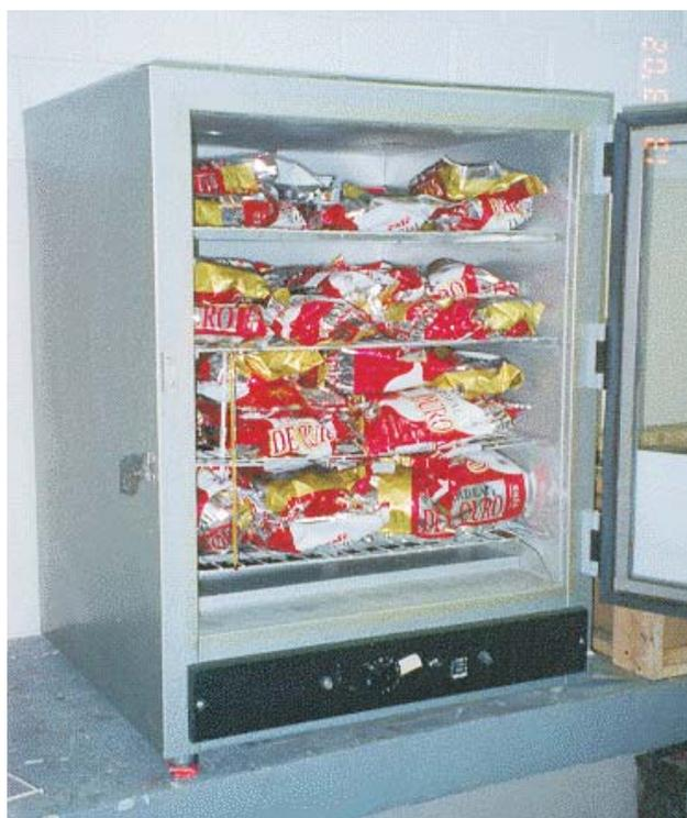
**Figura 3.12**- Corpos-de-prova embalados na estufa para equilíbrio da umidade interna
