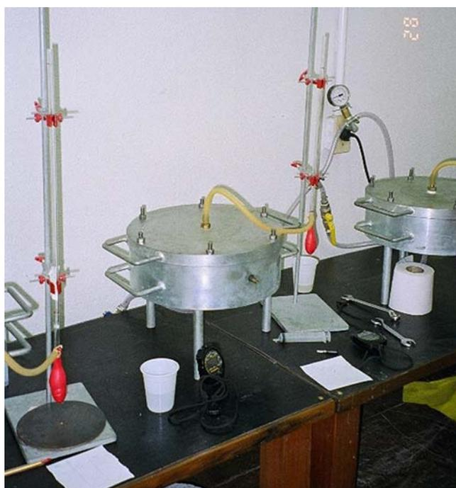
**Figura 3.26** - Ensaio de permeabilidade ao oxigênio
