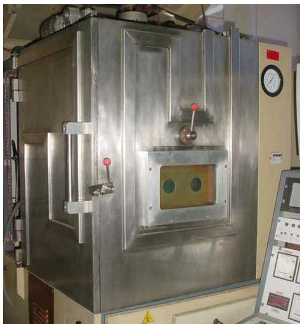
Figura 4.3: Dimensões internas da câmara de *Ion Plating*      Figura 4.4: Câmara de *Ion Plating* do LAMEF
