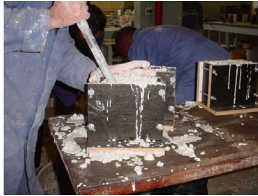
Figura 5.3 – Procedimento utilizado para adensamento dos concretos.
