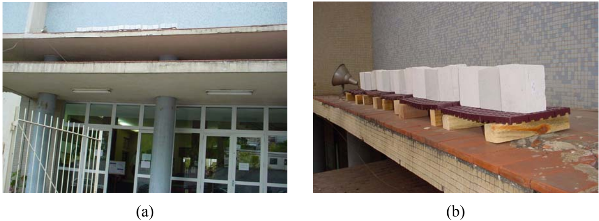
Figura 5.9 – (a) Local de exposição das amostras de concreto; (b) Detalhe da exposição.
