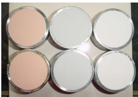
Figura 6.11 – Pastilhas de metacaulim, sílica ativa e cimento utilizados para as leituras colorimétricas.
