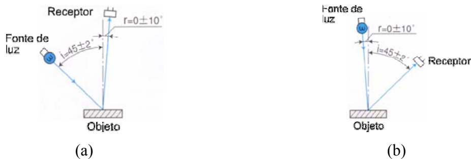
Figura 4.3 – Opções de geometria dos sistemas de iluminação unidirecional – (a) 45/0 ; (b) 0/45 [Adaptado: Minolta, 1998].
