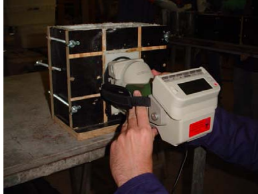
Figura 5.7 – Leituras colorimétricas do concreto no estado fresco.
