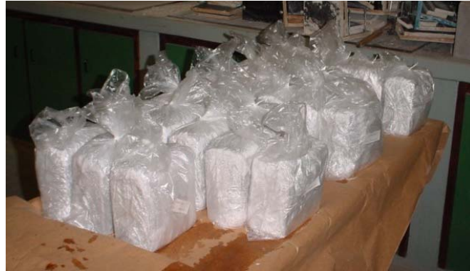
Figura 5.5 – Procedimento adotado para cura dos concretos destinados à leitura de cor.
