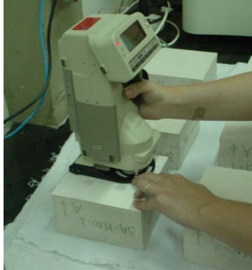
Figura 5.6 – Leituras colorimétricas com equipamento espectrofotométrico.
