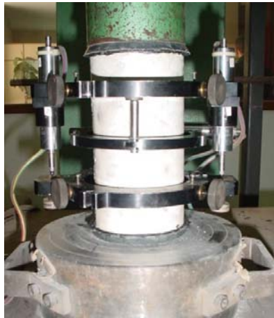
Figura 5.4 – Esquema do ensaio de módulo de deformação do concreto.
