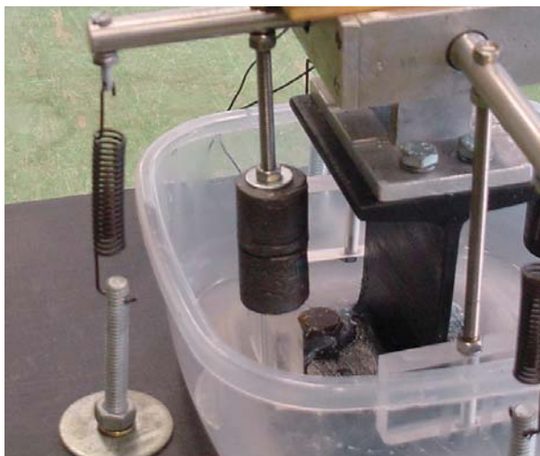
Figura 3.8 – Lastro de massas utilizado no ajuste do momento de inércia de massa.
