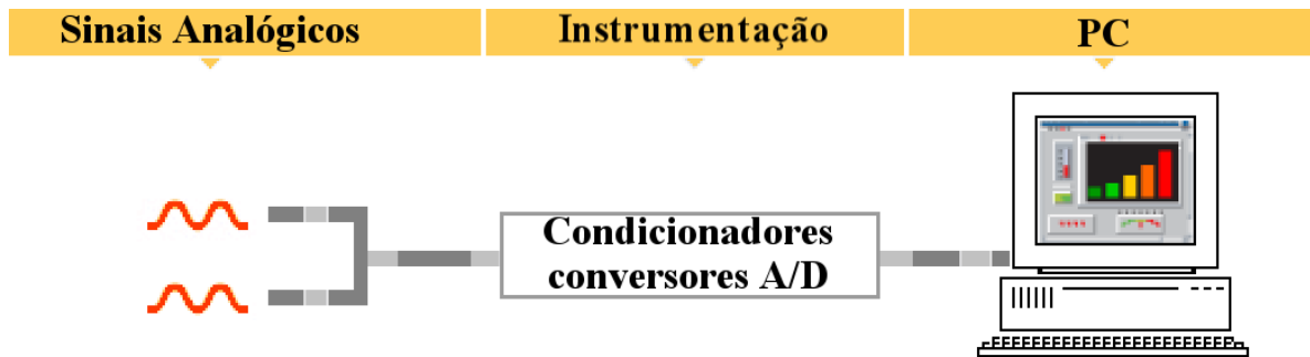
Figura 62 Sistema elementar de aquisição de dados
