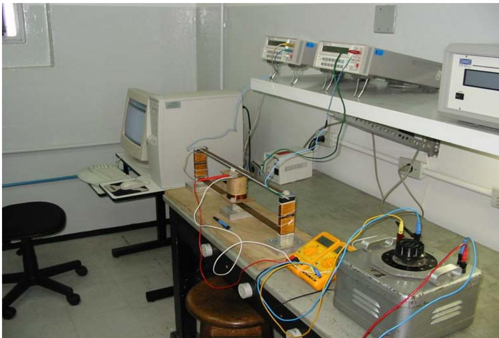
FIGURA 75 – Foto da montagem da experiência do transdutor com entreferro de medição e fluxo magnético c.a.
