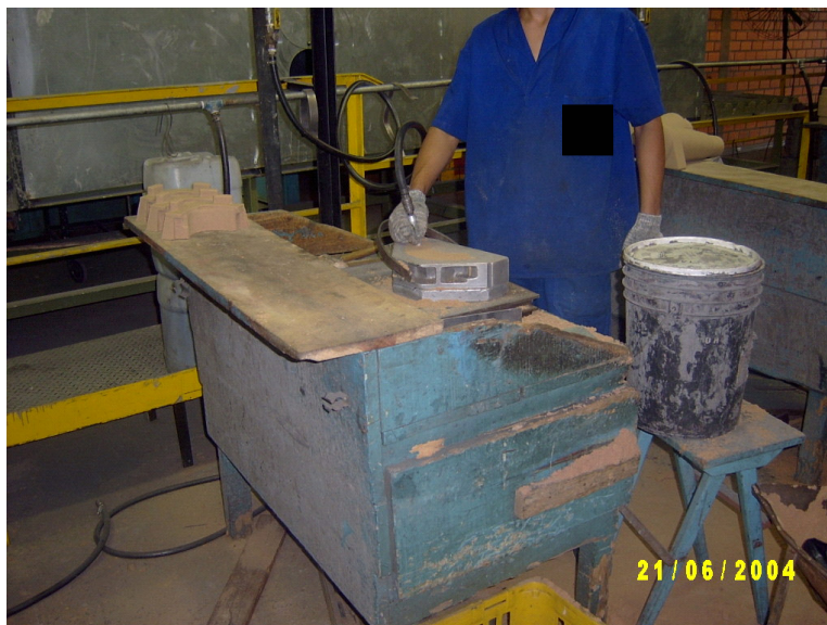
Figura 11 Injeção de dióxido de carbono (CO 2 )
