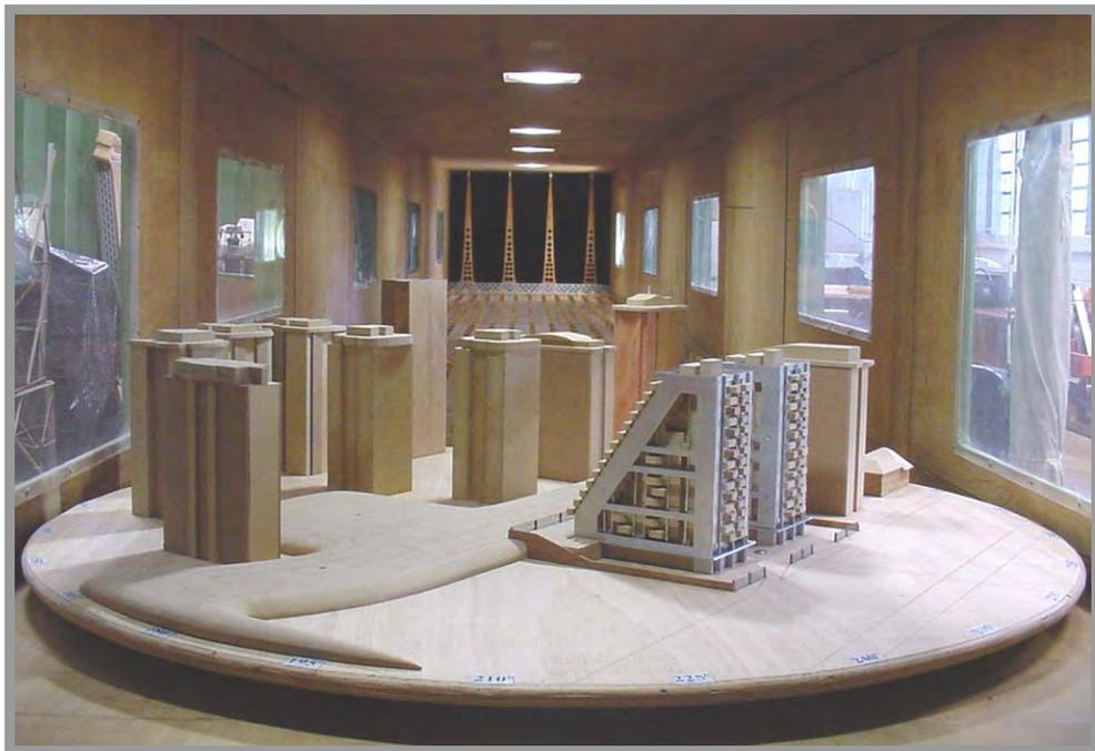
**Figura 3.48 - Modelos dos edifícios *Sundeck Residence* no interior do túnel de vento.**
