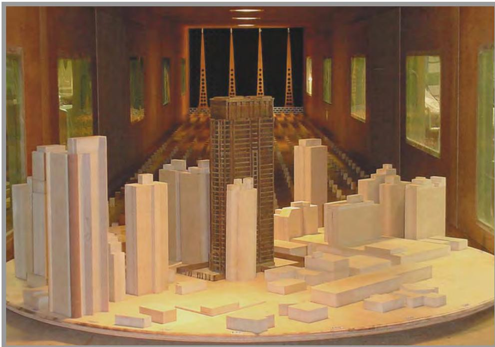
Figura 3.16 – Modelo do edifício *L'Essence Jardins* no interior do túnel de vento.
