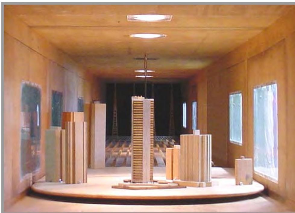
**Figura 3.11 – Modelo do edifício Torre de Málaga no interior do túnel de vento.**
