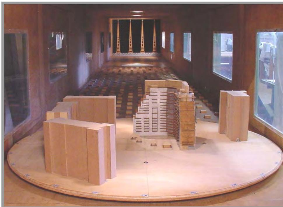
**Figura 3.43 - Modelo do edifício *Mandarin* no interior do túnel de vento com os edifícios a construir.**
