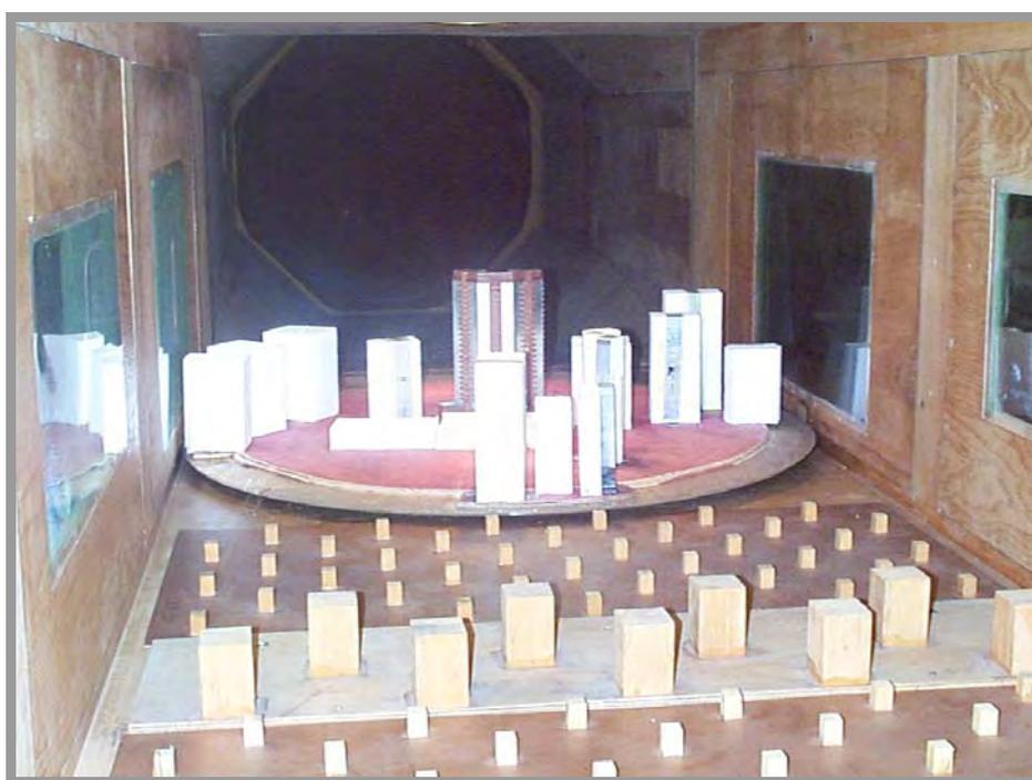
Figura 3.31 - Modelo do edifício *Cyrela Classique Klabin* no interior do túnel de vento.
