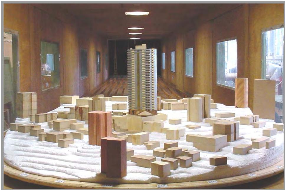
Figura 3.53 - Modelo do edifício *Sunset Residence* no interior do túnel de vento.
