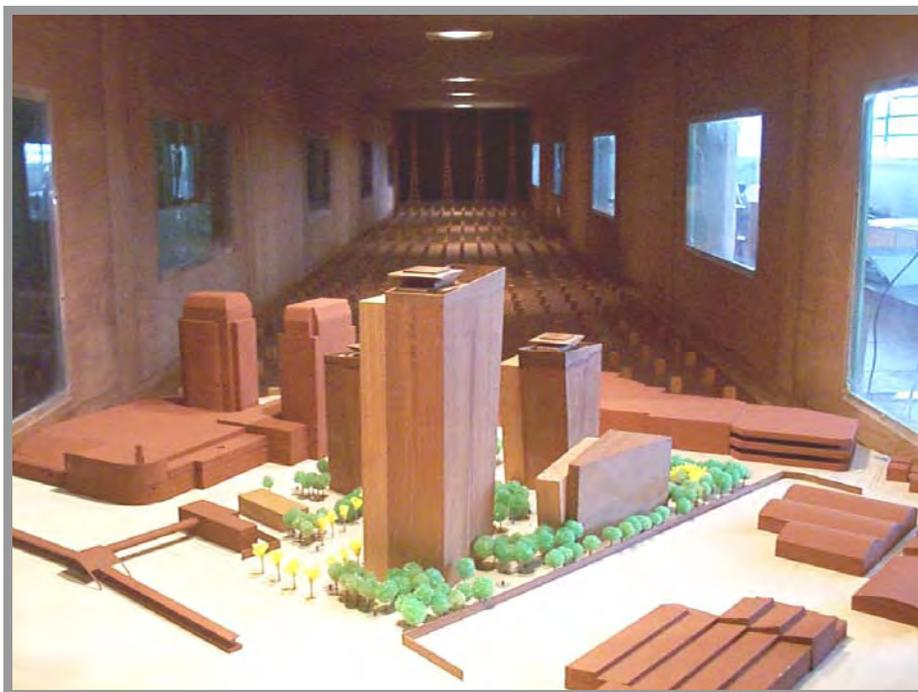
Figura 3.18 - Modelo dos edifícios do complexo *RochaVerá* no interior do túnel de vento.
