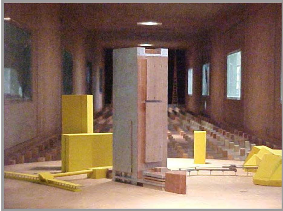
Figura 3.36 - Modelo do edifício *Gafisa-Eldorado* no interior do túnel de vento.
