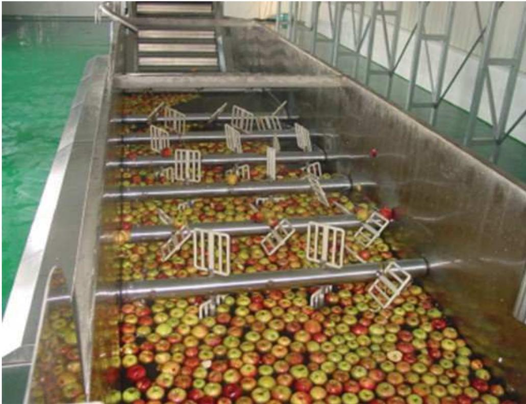
Figura 20: Sistema de Lavagem de Maças por Imersão. Fonte: Napead/UFRGS (2011).
