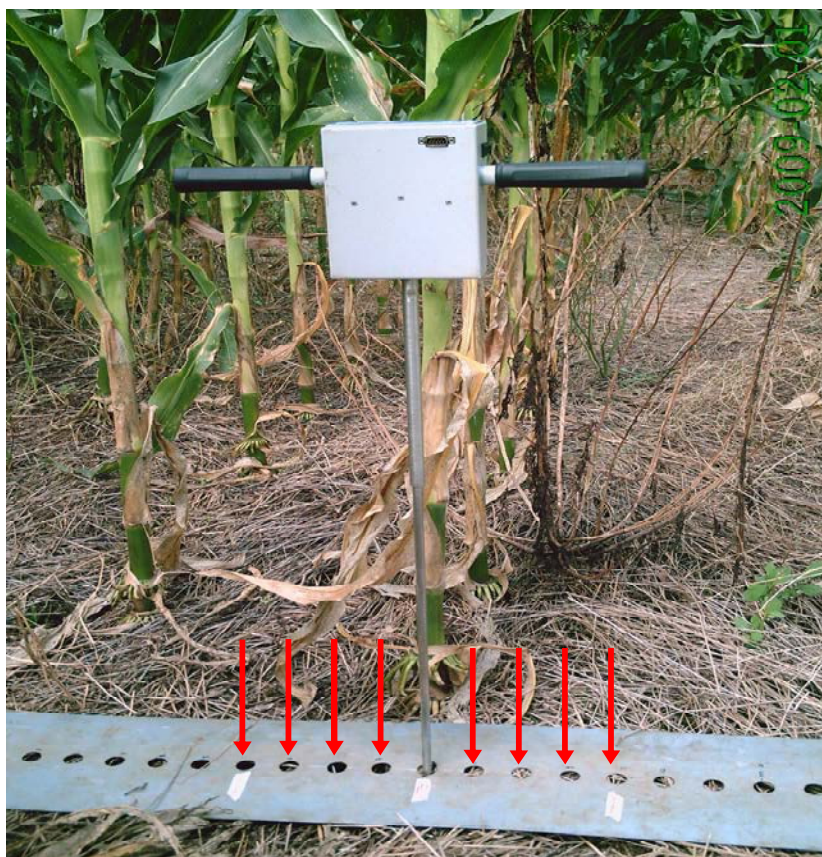
Figura 10. Esquema de determinação da resistência mecânica à penetração em transectos transversais às linhas de semeadura, com espaçamento de 0,05m entre as amostragens. Eldorado do Sul, 2009.
