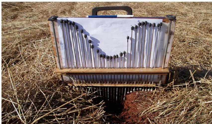
Figura 11. Vista frontal do perfilômetro instalado transversalmente ao sulco de semeadura. Eldorado do Sul, 2010.
