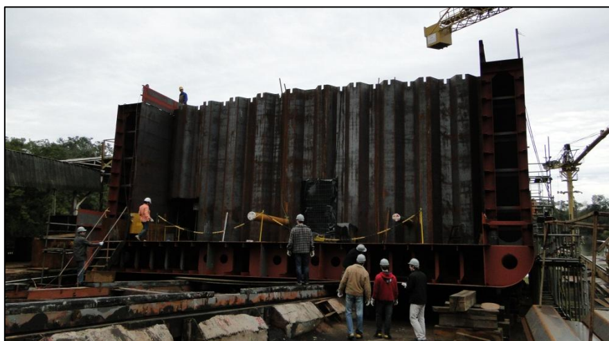
Figura 1.4 – Barçaça sendo montada no estaleiro em Taquari
