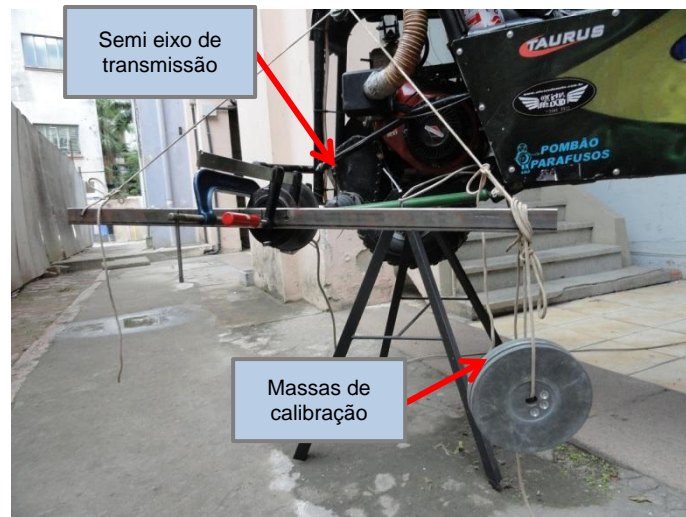
Figura 4.4 – Calibração da medição de torque.
