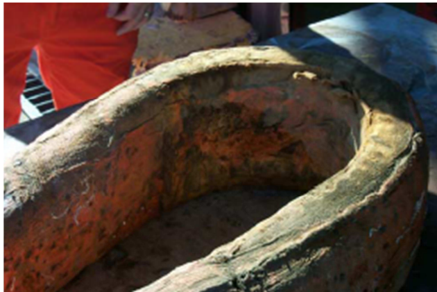
Figura 1.1 – Apresentação do problema, cabo deformado.
