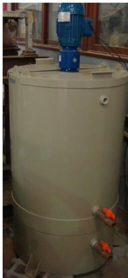
Figura 23: Misturador de calda de cimento
