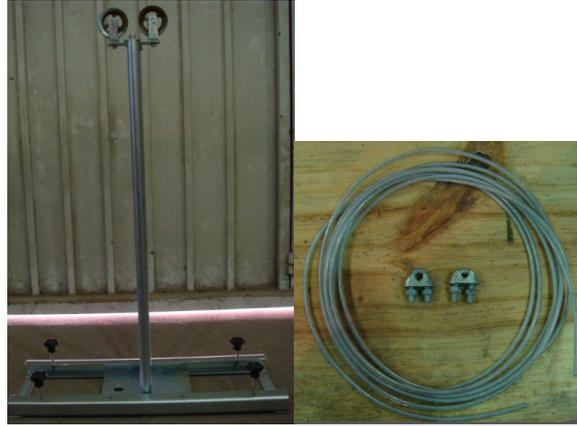
Figura 41: Sistema de prova de carga, cabo de aço e presilhas
