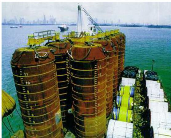
Figura 7: Âncoras de sucção (Randolph *et al.*, 2005)
