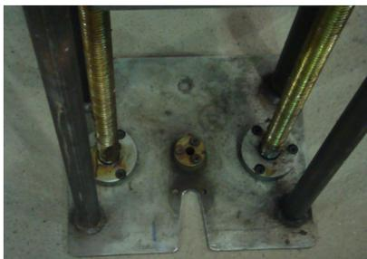
Figura 35: Rasgo na base do sistema de cravação
