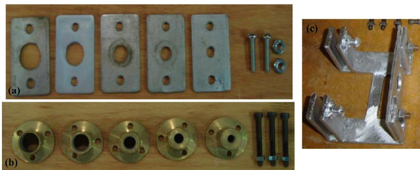
Figura 37: Peças de alinhamento dos tubos de aço-carbono
