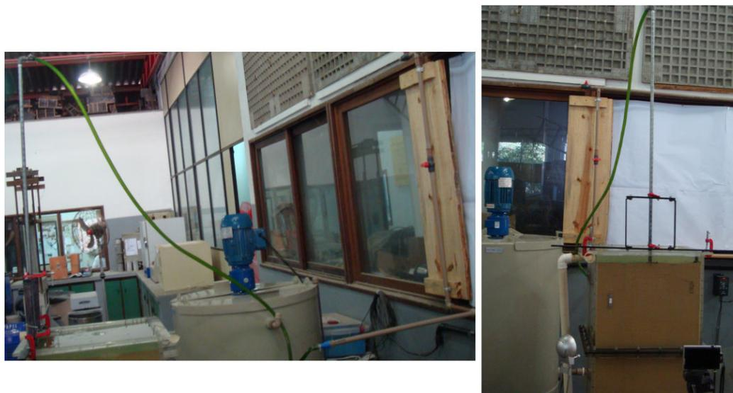
Figura 49: Montagem do ensaio de fluidização na lateral do tanque
