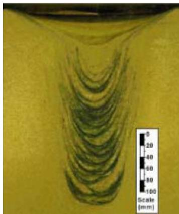
Figura 17: Técnica de fluidização aplicada a barreiras de tratamento (Niven, 2001)
