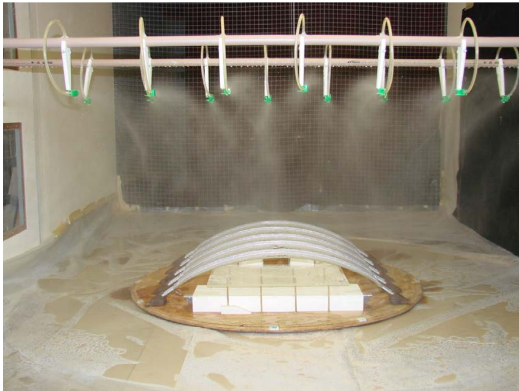
Figura 4.25 – Modelo estudado Fase II – Configuração II: Placas Horizontais Sem Vento.
