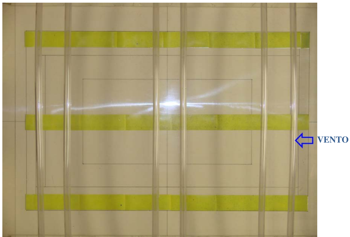
Figura 4.44 – Modelo estudado Fase II – Configuração III: Placas Inclinadas Vento 180°.
