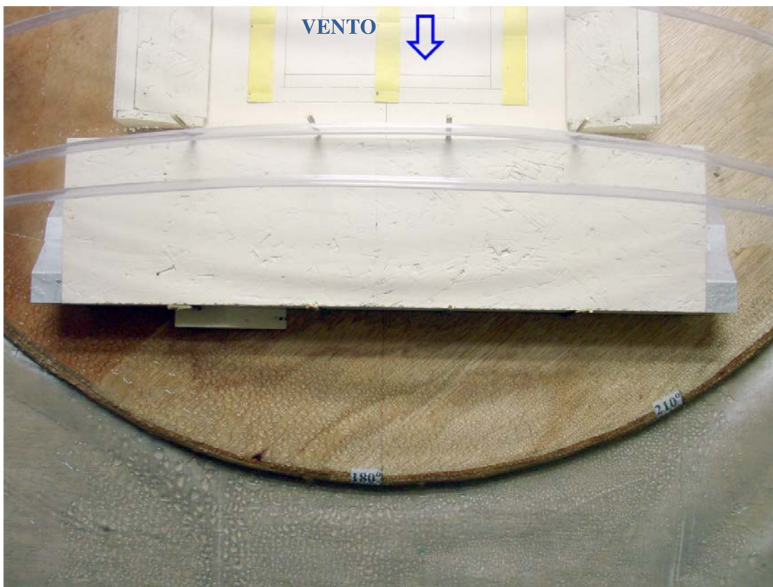
Figura 4.28 – Modelo estudado Fase II – Configuração I: Sem Placas Vento 0°.
