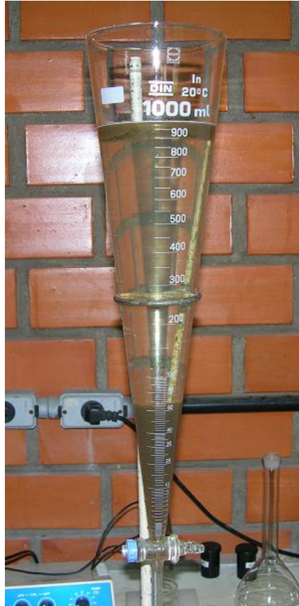
Figura 12. Tratamento convencional de DAM no Cone de Imhoff. Tratado com NaOH
