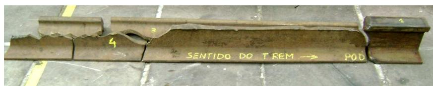
Figura 3.1 Fragmentos de trilho utilizados para análise e caracterização.
