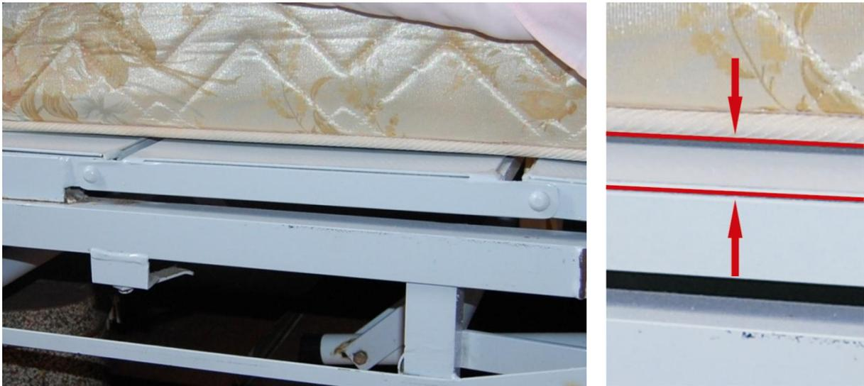
Figura 20 – Exemplo de colchão fora dos padrões estabelecidos pela NBR 13578 e detalhe que mostra que o colchão tem largura menor que a da cama.
