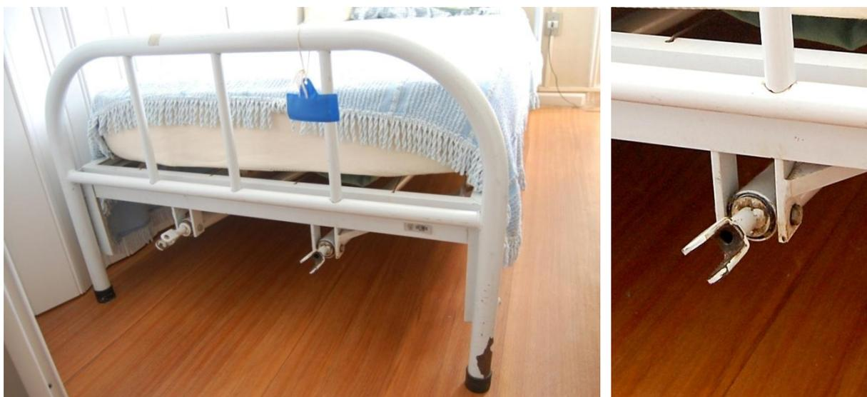
Figura 26 – Ausência de alavancas e detalhe do encaixe sem alavanca.
