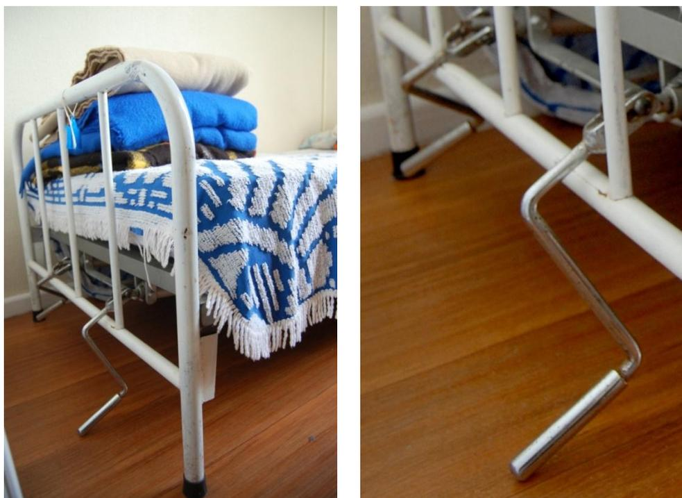
Figura 25 – Alavancas mal posicionadas e detalhe que evidencia as alavancas.
