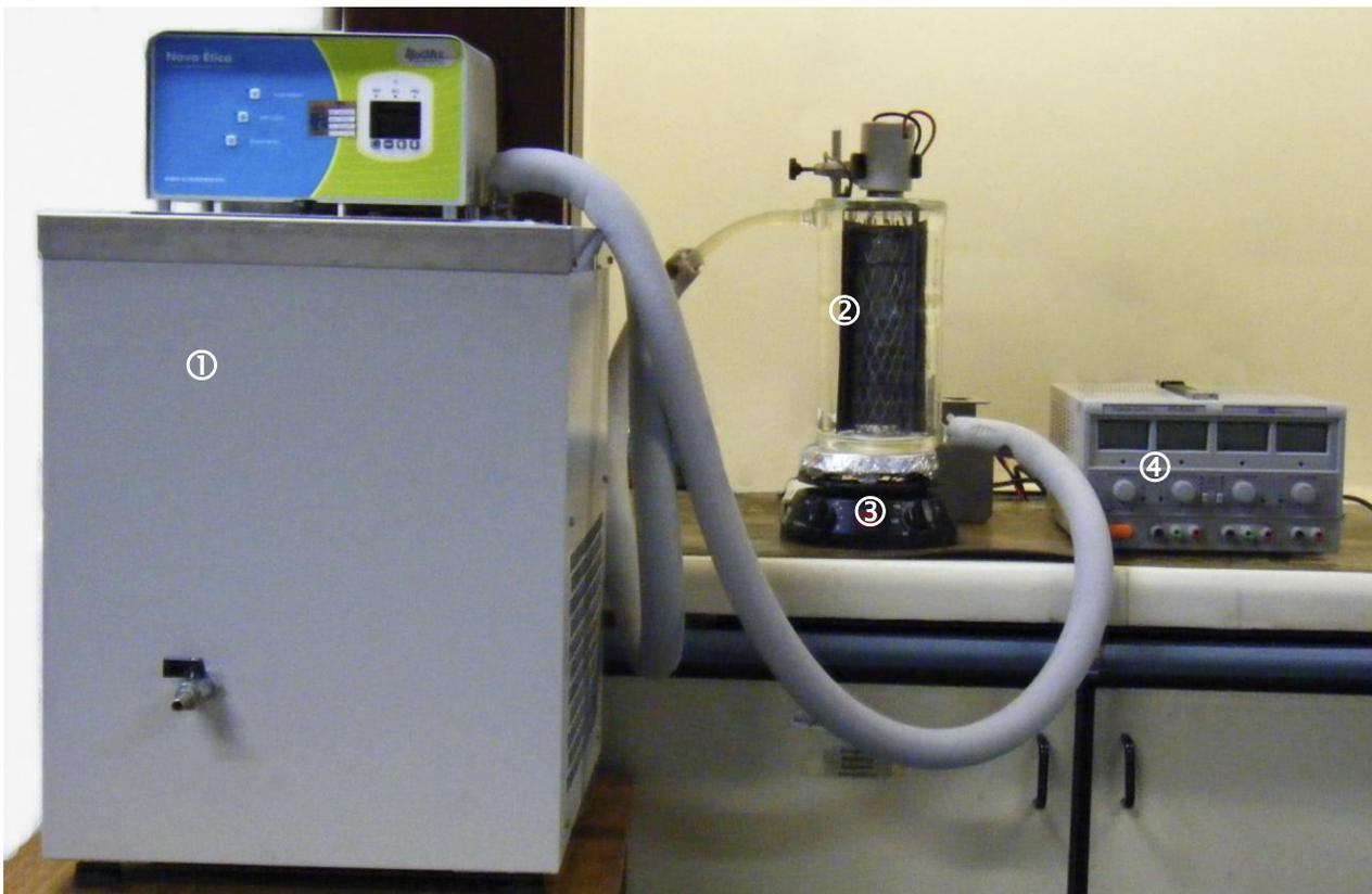
**Figura 9:** Aparato experimental utilizados nos experimentos de EL e FEO. Sendo: 1) banho ultratermostático, 2) reator de vidro encamisado, 3) agitador magnético e 4) fonte de corrente.
