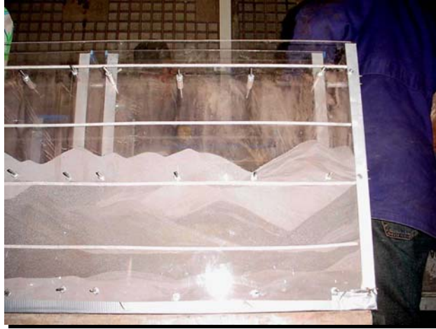
Figura 4.57 – Execução da terceira etapa de carregamento
