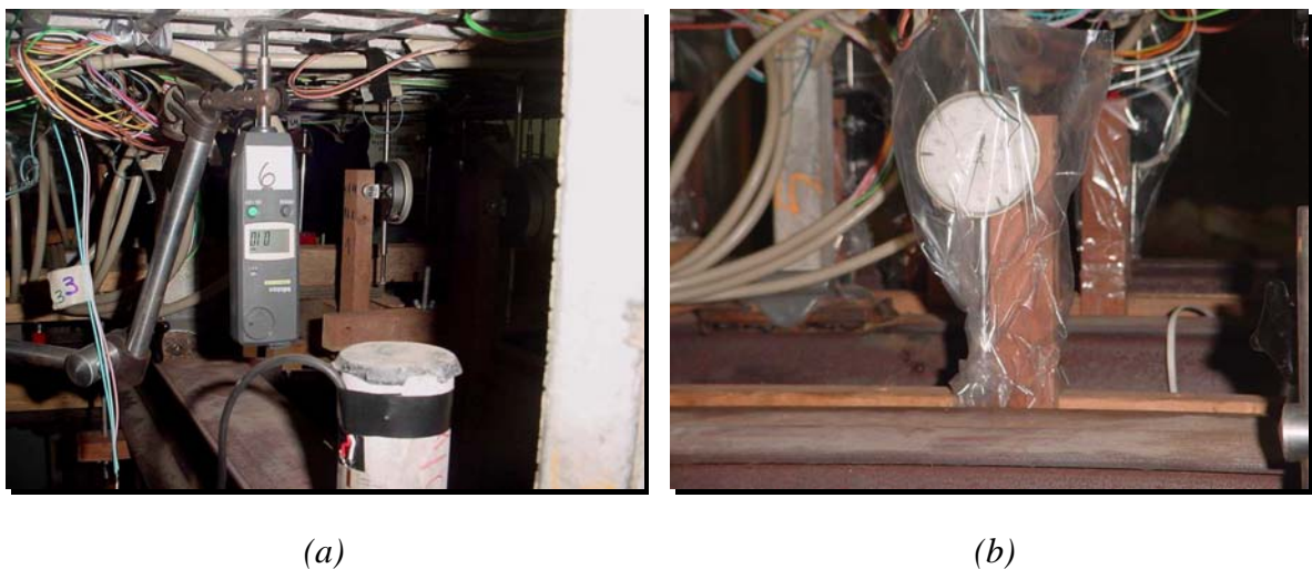
Figura 4.50 – (a) Deflectômetro digital em detalhe e (b) Deflectômetro analógico em detalhe
