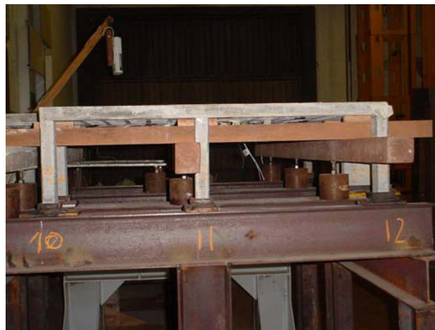
Figura 4.44 – Modelo posicionado com escoramento
