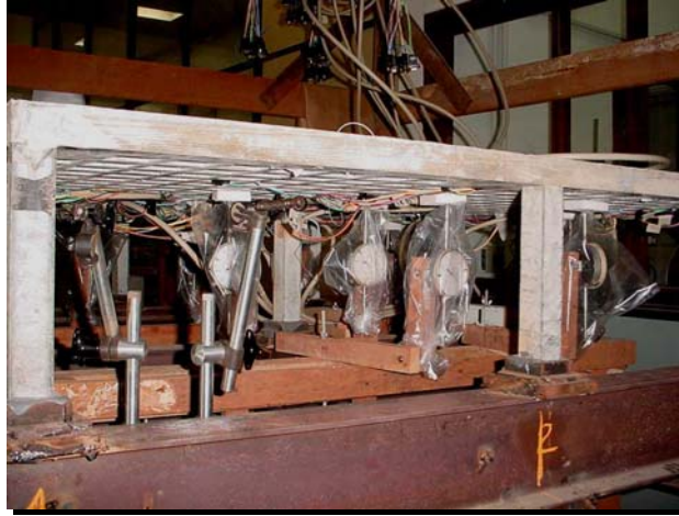
Figura 4.51 – Vista geral dos deflectômetros posicionados sob a laje
