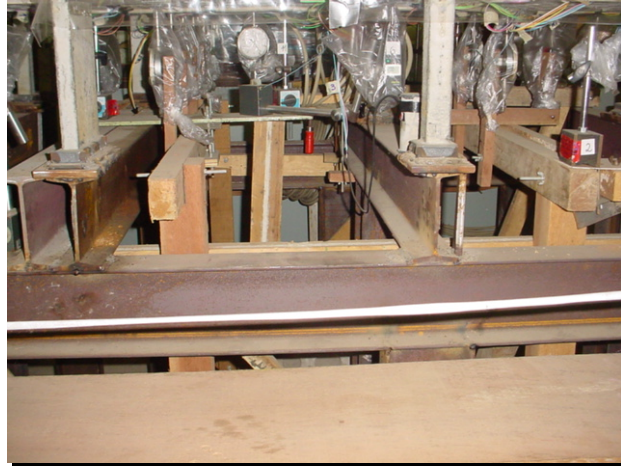
Figura 4.49 – Estrutura de madeira para fixação dos deflectômetros
