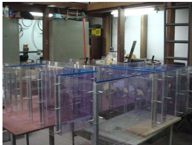
Figura 4.39 – Estrutura de acrílico montada
