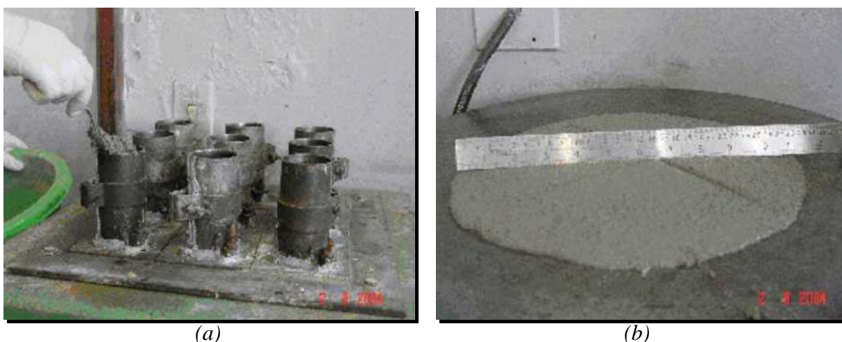
Figura 4.2 – (a) Moldagem dos corpos-de-prova sobre a mesa vibratória e (b) “Flow Test”
