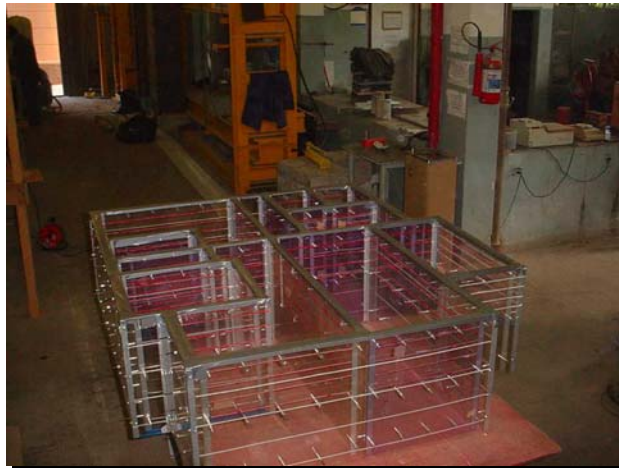
Figura 4.41 – Estrutura de acrílico vedada
