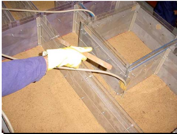
Figura 4.58 – Finalização do carregamento de areia
