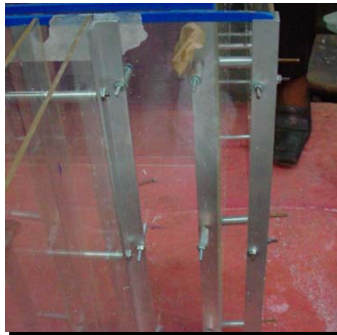
Figura 4.38 – Detalhe da montagem da estrutura de acrílico
